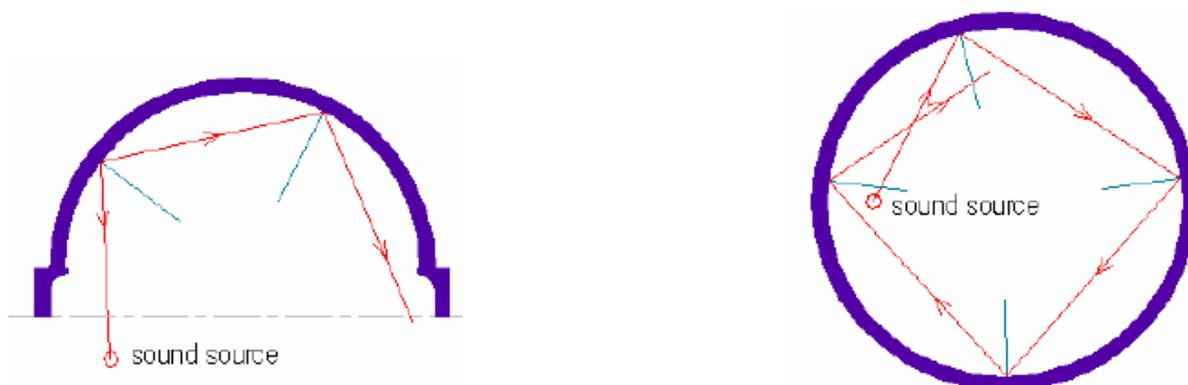
Figura 4.44 – Comportamento da energia sonora na cúpula: à esq., corte da cúpula; à dir., vista da cúpula em planta [9].
