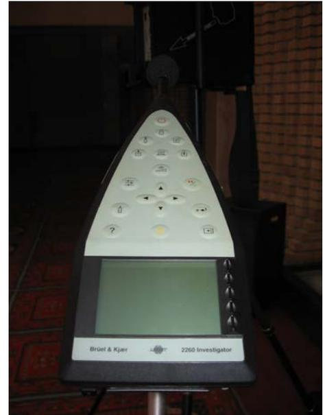
Figura 5.25 - Sonómetro Brüel & Kjær modelo 2260 [Foto da Autora].
