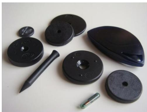
Figura 46. Exemplo de várias formas que os RFID podem adoptar. Fonte: [35]
