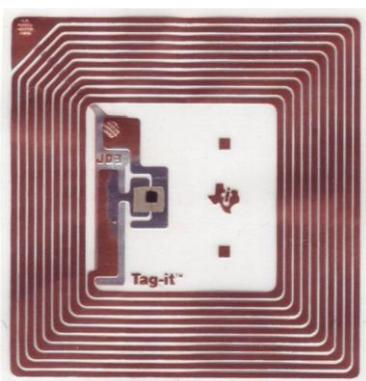
Figura 45. Exemplo de tag de RFID, passivo
