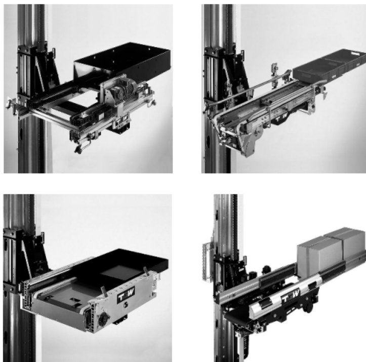
Figura 2.15: Sistemas de extracção para extracção de cargas leves
