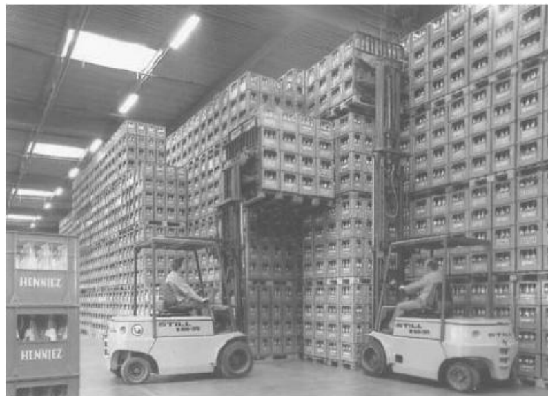
Figura 2.3: Armazenagem sobre piso
