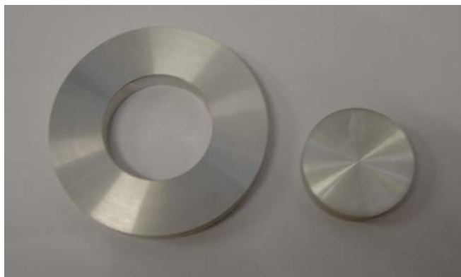
Figura 7.8 Elementos do provete de calibração anel/disco
