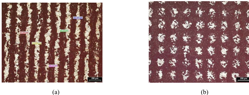
Figura 6.1 Redes transferidas para o Al: rede de linhas paralelas com resolução de 4l/mm (a); rede de linhas cruzadas com resolução de 3l/mm (b).
