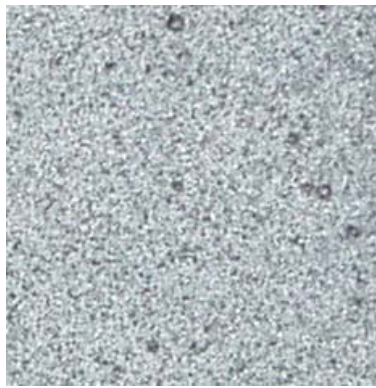
Figura 5.29 Superfícies pulverizada com spray muito fino (ampliação de 5x).
