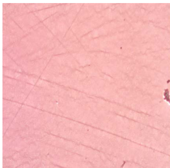
Figura 5.15 Revestimento da rede de silicone com Al na Amostra 2 numa zona de boa qualidade, ampliação 50X.
