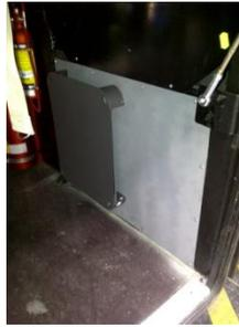
**Figura 29 – Tampas no interior das bagageiras, com cor incorrecta.**
