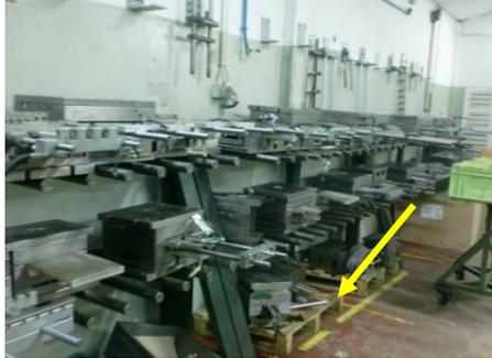
Figura 21: Molde colocado no chão
