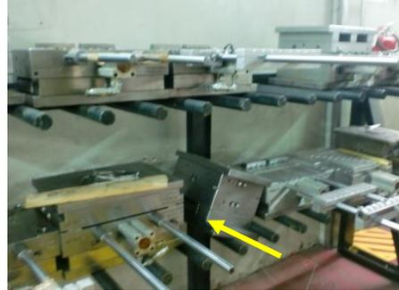
Figura 22: Molde colocado de forma inadequada
