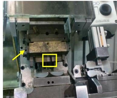
Figura 18: Placa de termogravação nova
