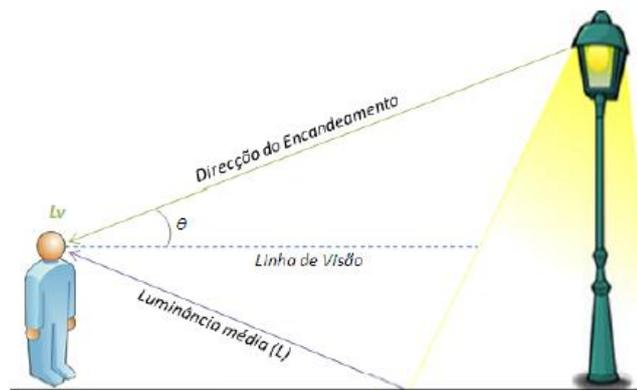
Figura 3.4-Esquemática dos parâmetros para o cálculo do TI [2]
