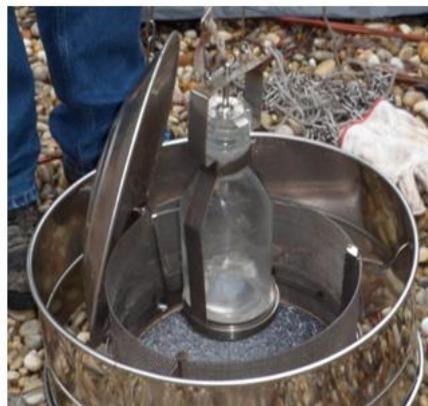
Fig. 4.4. – Colheita de amostras no interior do reservatório
