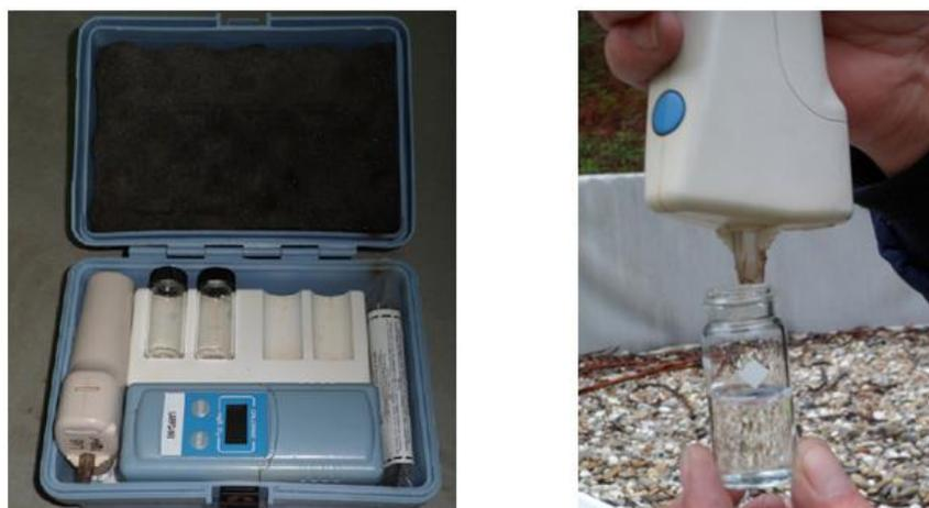
Fig. 4.7. – Medição “*in situ*” da concentração de cloro presente na água
