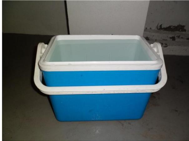
Fig.4.9 – Recipiente de armazenamento para controlo do decaimento de cloro
