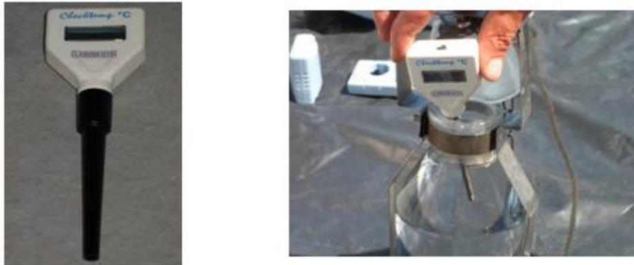
Fig. 4.6. – Medição “*in situ*” da temperatura da água
