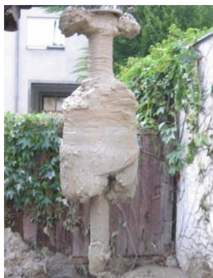
Figura 2.14 – Aspeto do efeito “saca rolhas” num solo argiloso (Falk et al., 2009)
