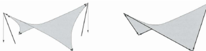
Fig. 2.64 – Estrutura com bordos flexíveis e rígidos, esquerda e direita respectivamente
