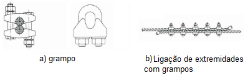
Fig. 2.13 – Representação de grampo e ligação realizada com grampos
