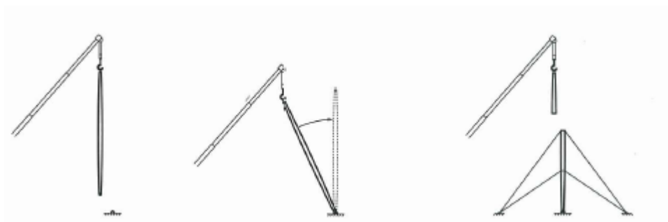
Fig. 6.31 – Içamento de um mastro
