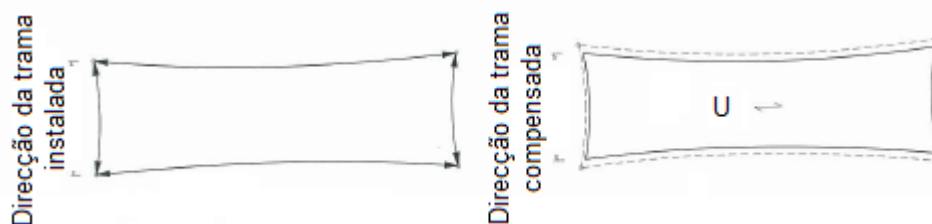
Fig. 2.47 – Tira de membrana compensada nas direcções do urdume e da trama, ante de ancorada no pontos fixos
