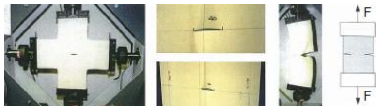
Fig. 2.44 – Ensaio biaxial e uniaxial de propagação de rasgos
