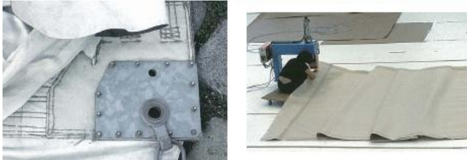
Fig. 2.59 – Esquina de uma tenda de circo reforçada com juntas costuradas e costura de um bordo de uma fibra de vidro revestida a PTFE
