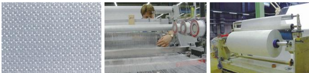
Fig. 2.32 – Fibra de vidro revestida a silicone e produção
