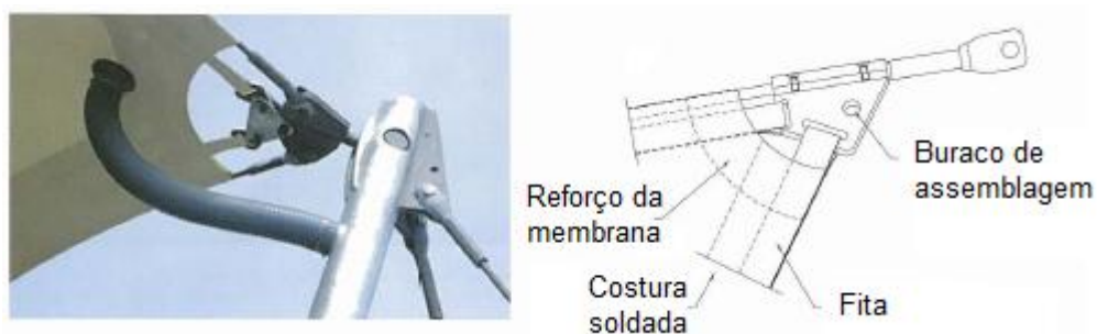
Fig. 2.24 – Fixação de fitas de bordo a elemento construtivo
