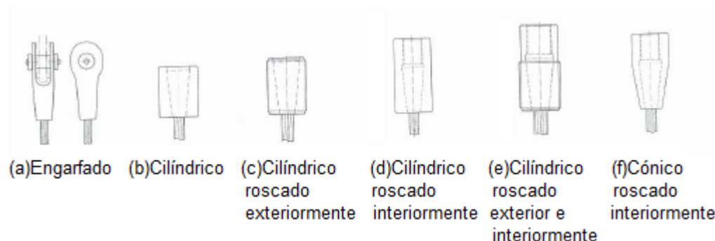
Fig. 2.15 – Ligação do tipo encaixe zincado
