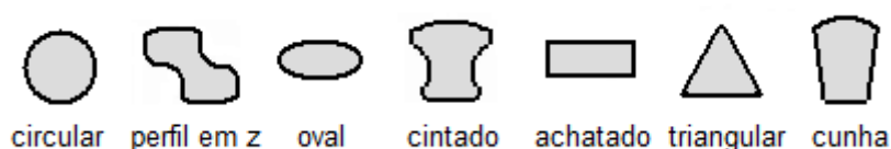
Fig. 2.1 – Tipo de arame quanto à forma da secção
