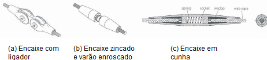
Fig. 2.14 – Tipos de conectores de extremos de alta resistência
