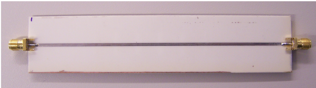
Figura 3.11: Fotografia do filtro implementado - linha microstrip
