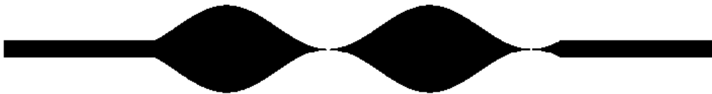
Figura 6.9: Linha microstrip com dois períodos sinusoidais.
