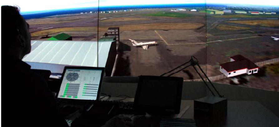
Este simulador dispõe ainda de sistemas auxiliares, capazes de gerar atrasos ou erros em mensagens ou informações, capazes de permitir usar pseudo-pilotos e efectuar acções sobre estes e ainda sistemas capazes de simular interacção entre pseudo-pilotos e o controlador que está a utilizar o simulador. Este último sistema pode ser utilizado independentemente do simulador como uma versão standalone de sistema de comunicação por voz.
