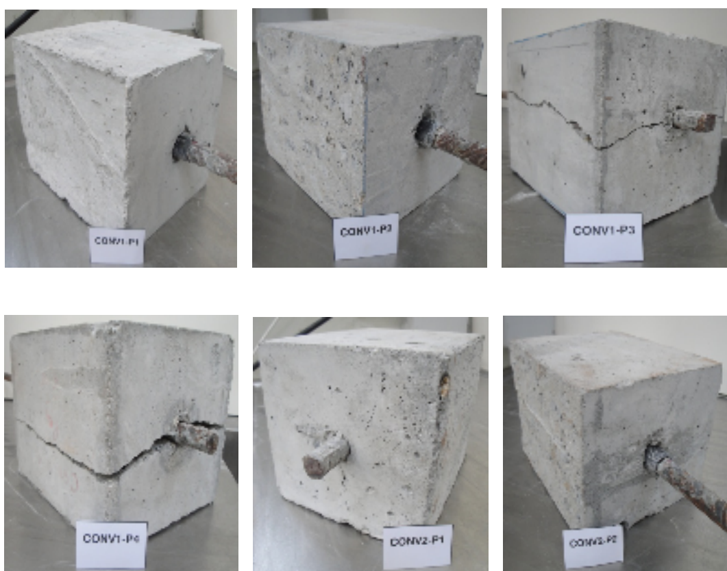
Figura 4.32.: Modos de rotura dos provetes de betão convencional
