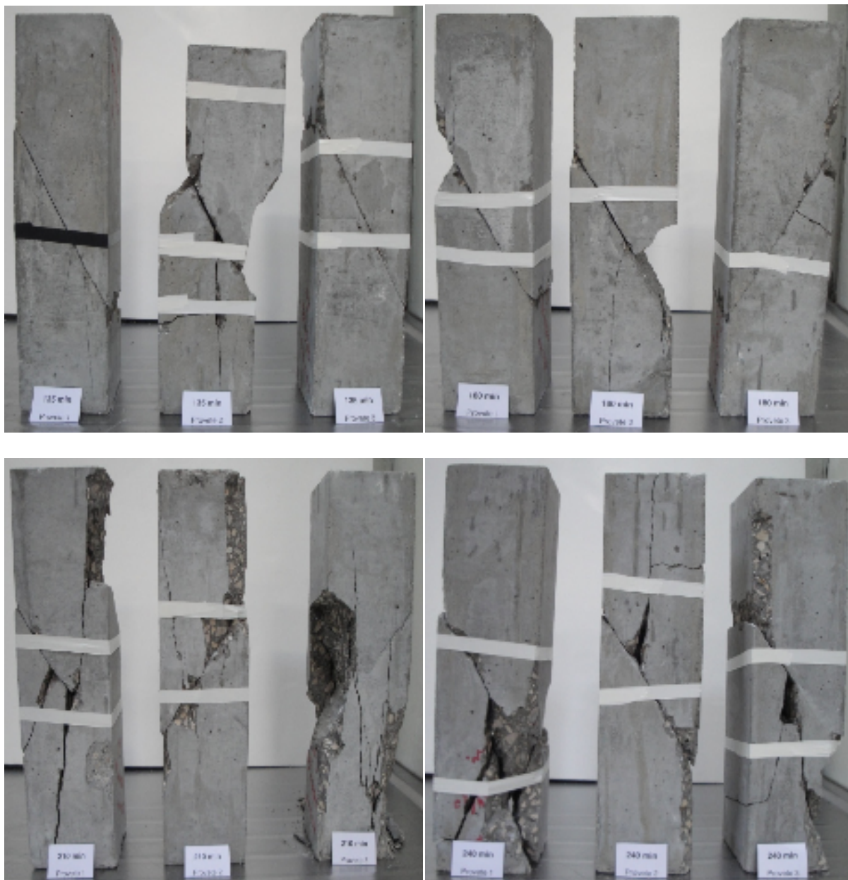
Figura 4.34. (continuação): Modos de rotura dos provetes de BAC
