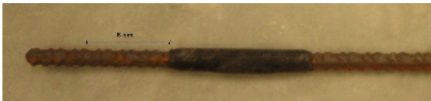
Figura 4.14.: Aspecto do varão inserido no interior do provete de betão. Zona isolada com manga plástica
