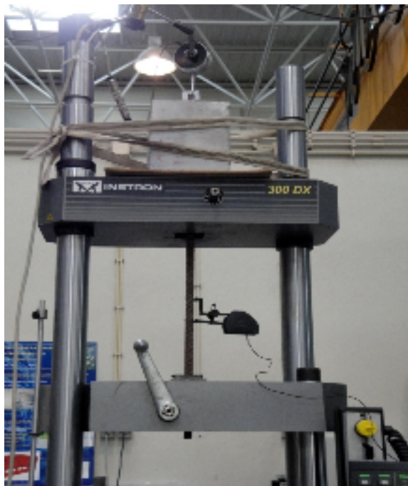
Figura 4.24.: Esquema do ensaio de arrancamento directo (pull-out test)
