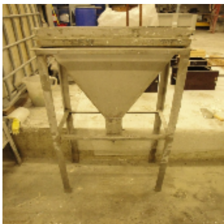
Figura 4.5.: Ensaio funil em V
