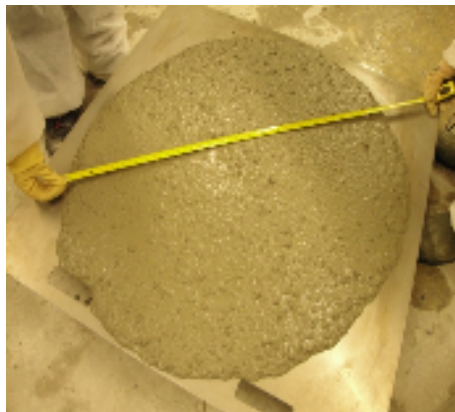
Figura 4.3.: Ensaio de espalhamento
