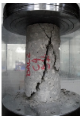
Figura 4.20.: Ensaio à compressão simples de carotes
