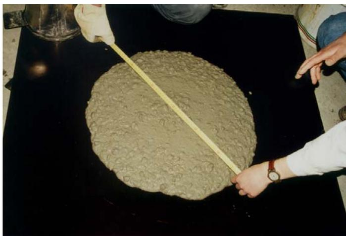
Figura 5.7 – Medição do diâmetro da área de espalhamento no “Ensaio de espalhamento do betão”
