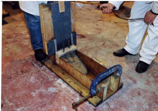
Figura 4.18 – Funcionamento do “Ensaio da caixa-L”
