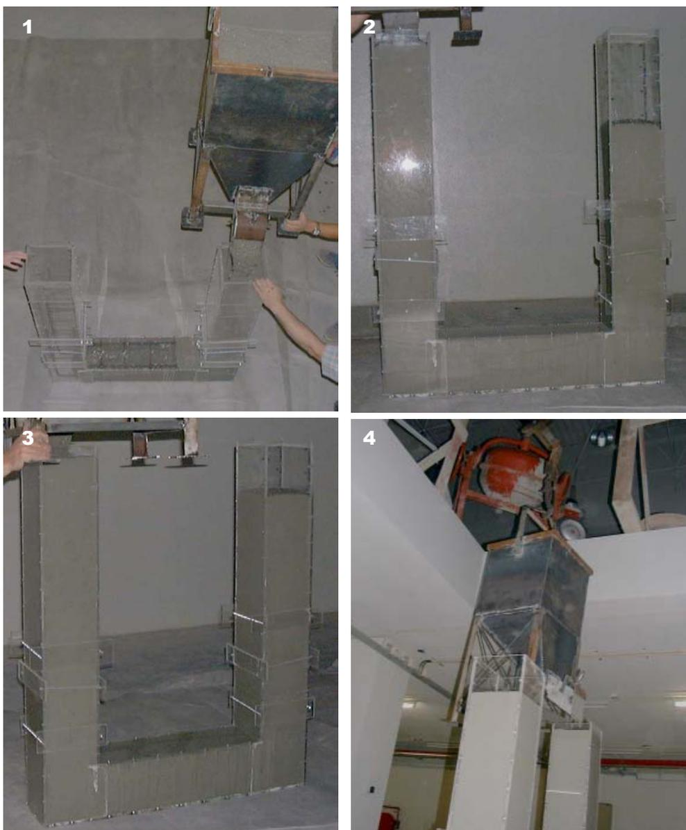
Figura 6.2 – Sucessivas fases do enchimento do molde, sob diferentes pontos de observação
