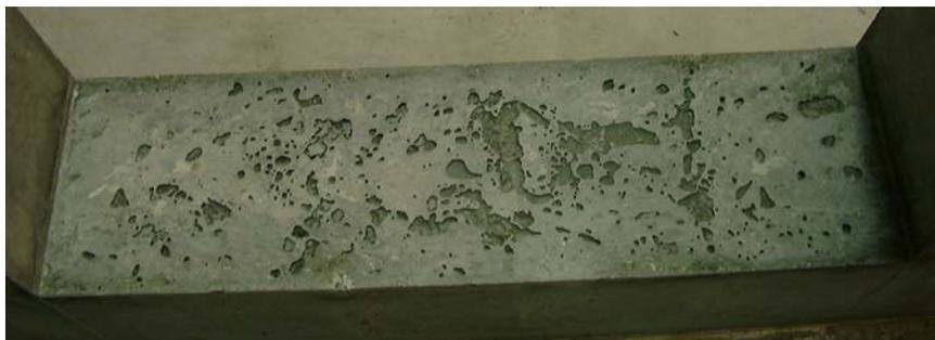
Figura 6.12 – Aspecto do betão na parte horizontal do molde devido ao ar acumulado
