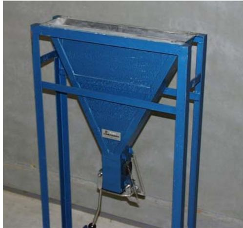
Figura 4.16 – Equipamento para o “Ensaio de fluidez”
