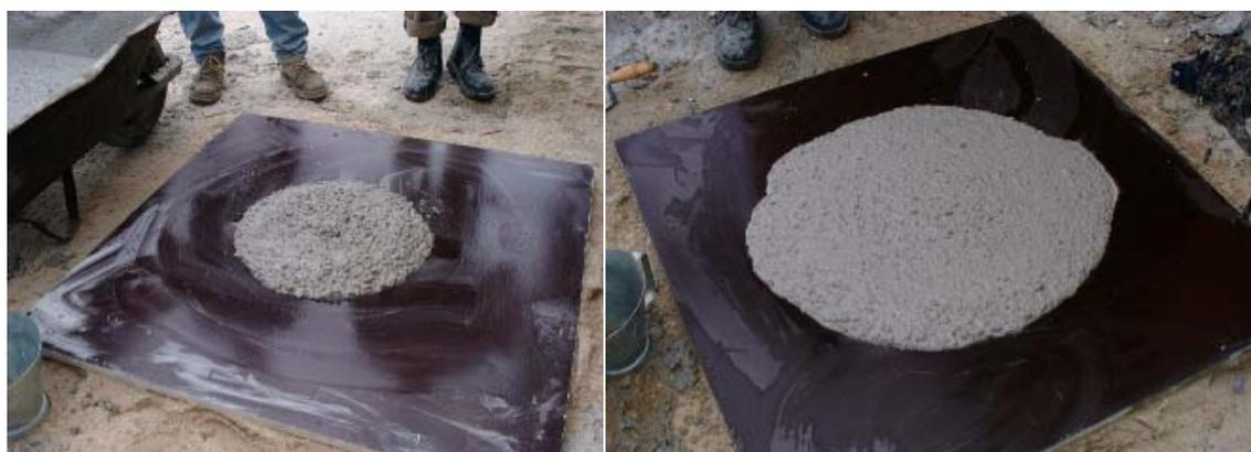
Figura 6.31 – Ganho de trabalhabilidade com a adição de superplastificante, na própria betoneira
