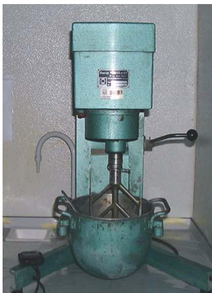
Figura 5.4 – Misturadora utilizada na amassadura das pastas
