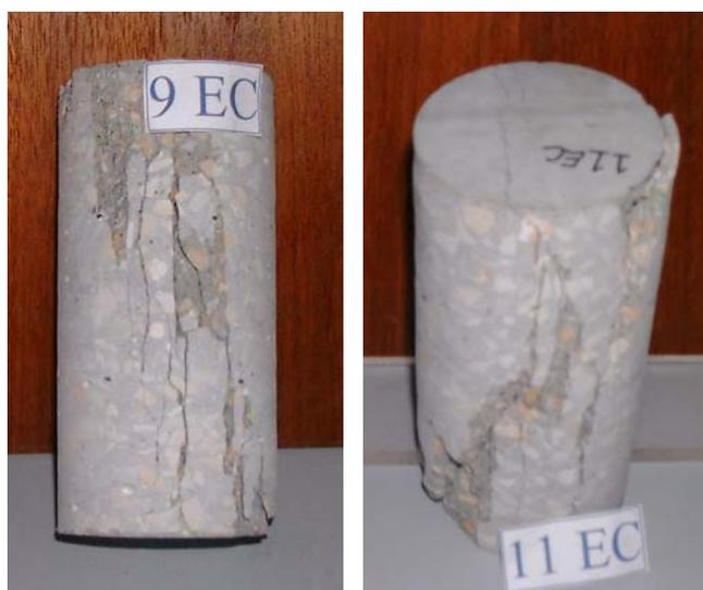
Figura 6.14 - Aspecto das carotes após a rotura por compressão
