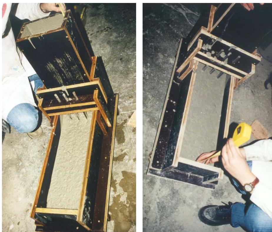
Figura 5.12 – Medição das alturas finais da amostra de betão
