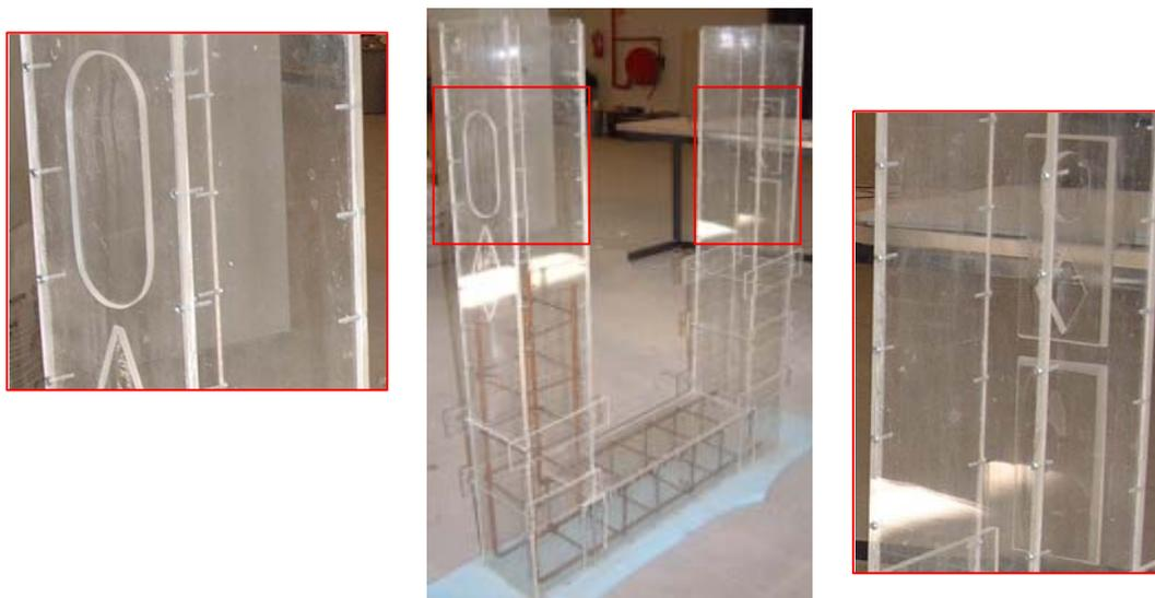
Figura 6.21 – Aspecto do molde utilizado e pormenor das placas com recortes de formas distintas, coladas no interior das paredes laterais
