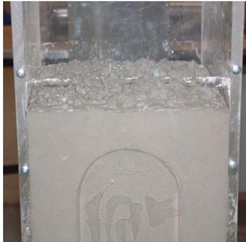
Figura 6.23 – Parte superior do betão na coluna da direita (onde o betão subiu) onde é possível observar bastantes partículas de agregado
