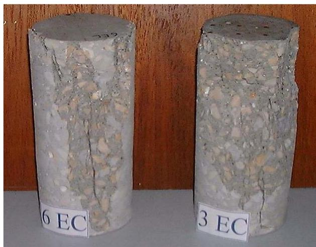
Figura 6.13 – Aspecto das carotes após a rotura por compressão
