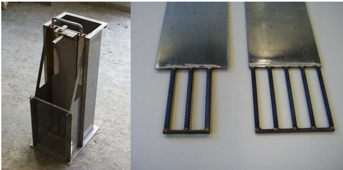
Figura 4.8 –Na esquerda o equipamento utilizado no “Ensaio da caixa”, na direita os obstáculos que se colocam no interior
