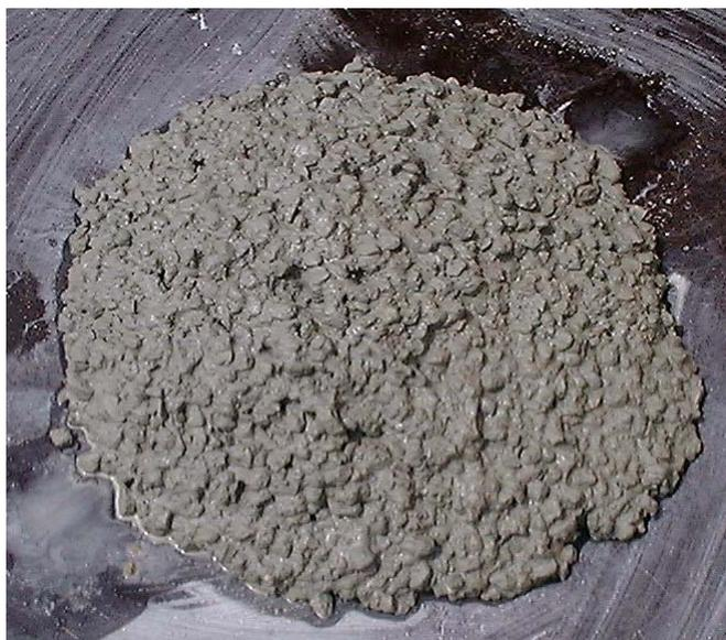
Figura 6.32 – Aspecto de uma amostra de SCC com um diâmetro de espalhamento insuficiente
