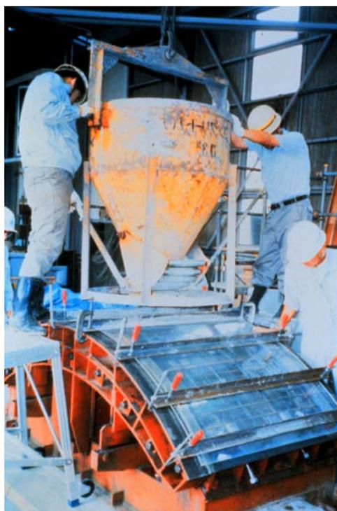
Figura 2.7 – Enchimento de um segmento para revestimento de túneis
