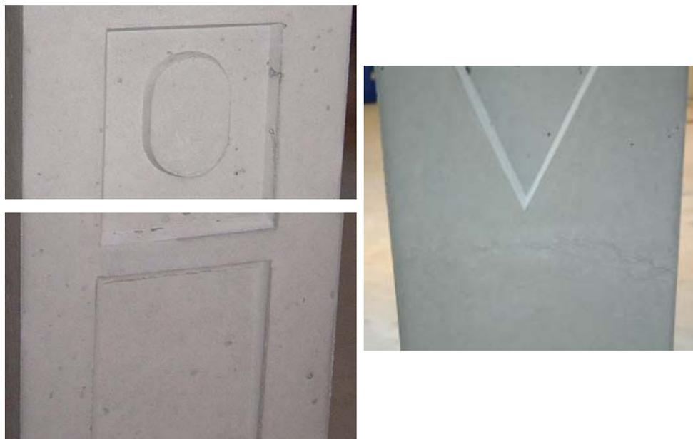
Figura 6.28 – Aspecto final da superfície do betão, na zona das placas com recortes
