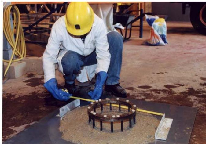
Figura 4.20 – Medição do diâmetro de espalhamento no final do “Ensaio do Orimet e do anel japonês”
