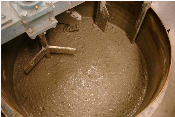
Figura 5.5 – Amassadura do betão na betoneira de eixo vertical
