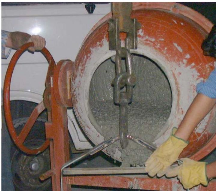
Figura 5.6 – Amassadura do betão na betoneira de eixo basculante
