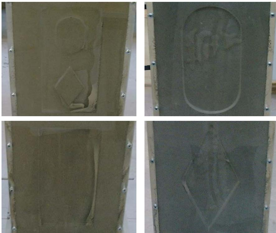
Figura 6.24 – Pormenor do preenchimento do molde junto às placas com recortes de formas distintas
