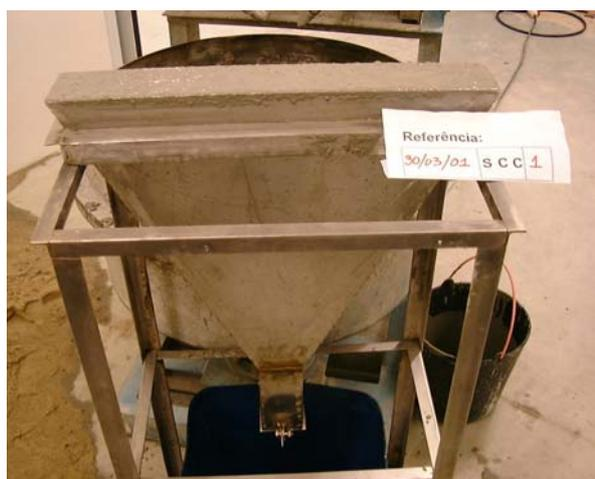
Figura 5.9– Funil utilizado no “Ensaio de fluidez do betão”
