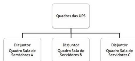
Figura 4.6 - Hierarquia do Subsistema Quadro das UPS
