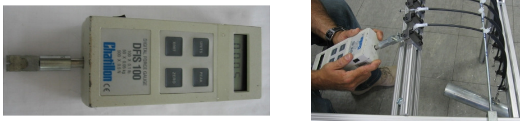
Figura 2. 5 Sistema de medição com dinamómetro
