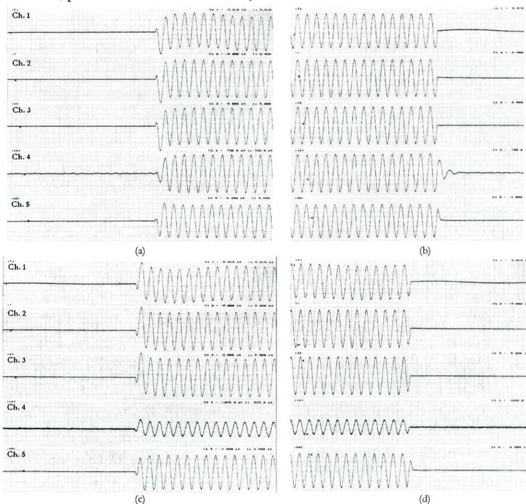
Figura 2.42 – Oscilogramas registados durante os ensaios. (a) Ligação da corrente monitorada pelo canal B . (b) Corte da corrente monitorada pelo canal B . (c) Ligação da corrente monitorada pelo canal A . (d) Corte da corrente monitorada pelo canal A .
