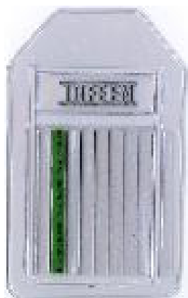
Figura 22 - IQI de fios segundo a norma NP EN 462-1
