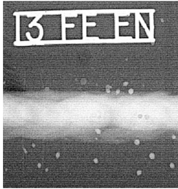
Figura 27 - Provete de Aço Inoxidável de 6mm, com tratamento de imagem.
