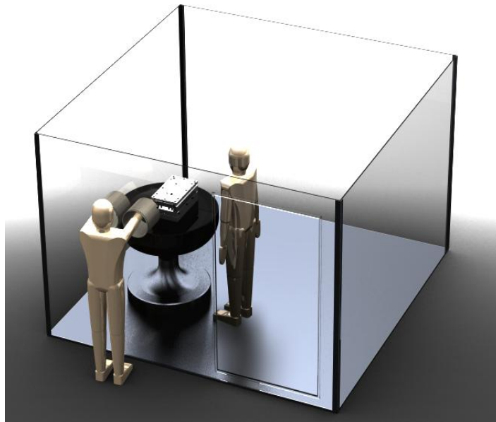
Figura 63 – Proposta de cabine de limpeza e pintura
