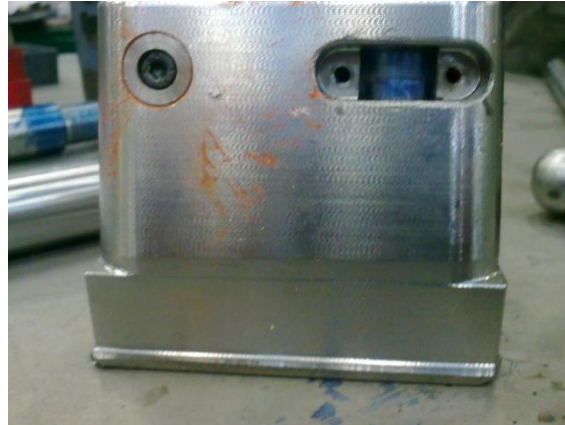
Figura 37 – Veio posicionado e pintado com uma tinta marcadora
