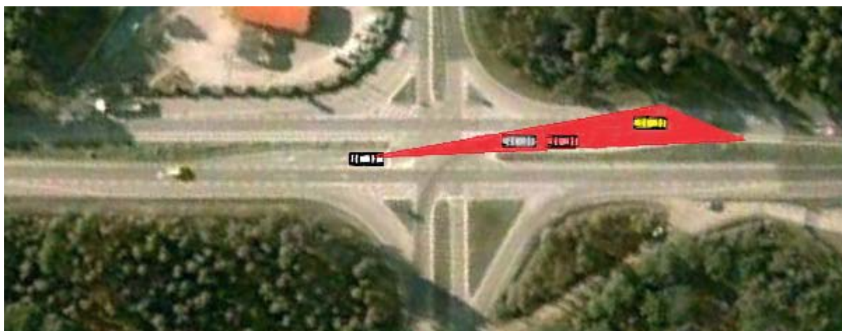
Figura 50 – Obstrução de visibilidade causada por veículos parados na via de viragem à esquerda (imagem elaborada pelo autor para este trabalho).
