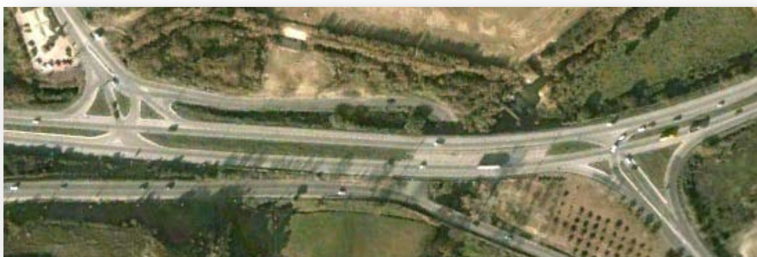
Figura 33 – Intersecção deslocada na estrada IC2 (imagem tirada do Google Earth para este trabalho).
