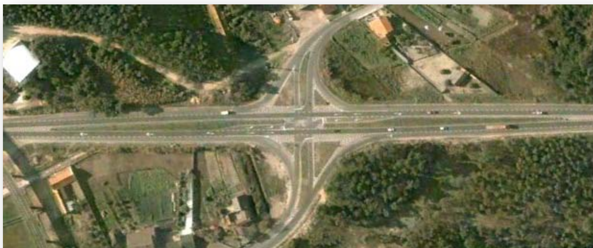
Figura 31 – Cruzamento na estrada N109 com canalização fisicamente materializada (imagem de satélite tirada do Google Earth para este trabalho).
