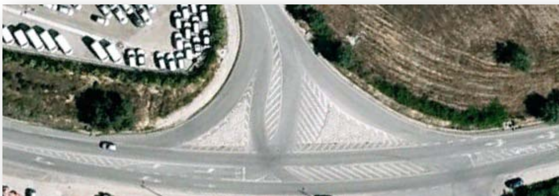
Figura 30 – Entroncamento na estrada N10 com canalização demarcada (imagem de satélite tirada do Google Earth para este trabalho).
