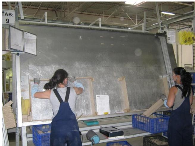
Figura 3.1 - Processo de montagem das molduras na área dos *Frames*
