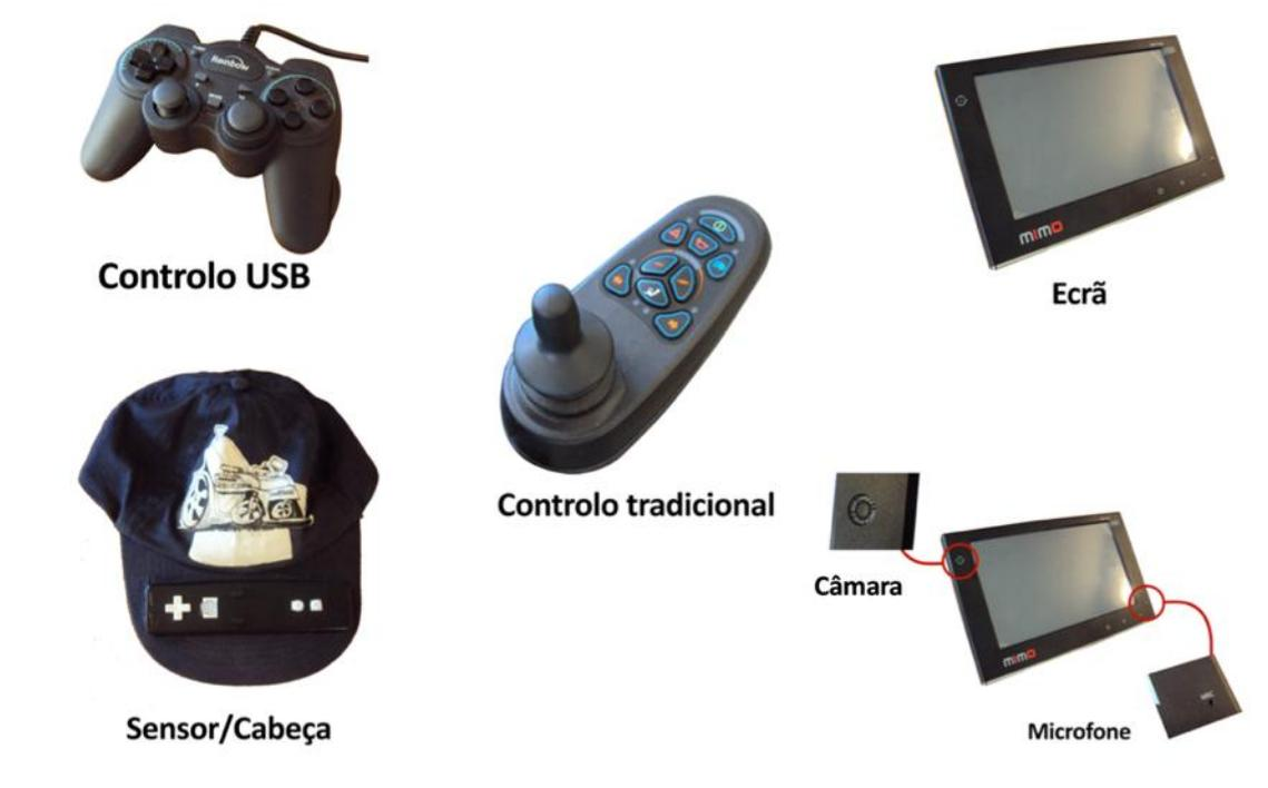
Figura 35 – Dispositivos da Cadeira de Rodas IntelliWheels
