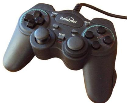
Figura 26 - Controlo USB da Cadeira de Rodas IntellWheels
