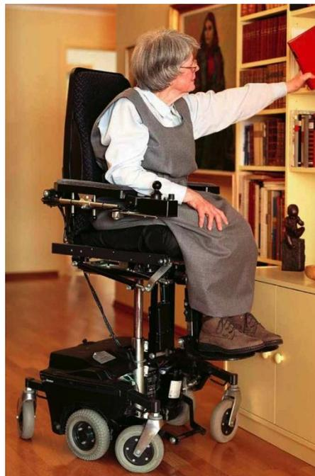
Figura 8 - Cadeira com assento de altura ajustável
