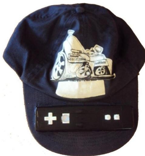
Figura 27 - Sensor de Movimento de Cabeça da Cadeira de Rodas IntellWheels
