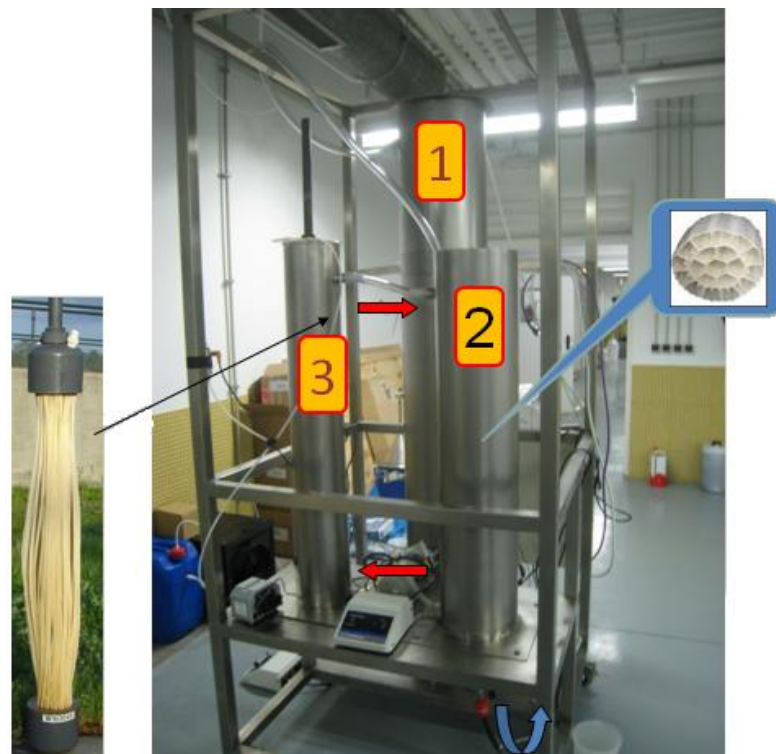
Figura 10: Imagem do Biorreactor de membranas de três etapas em escala piloto. (1) câmara UASB, (2) câmara aeróbia, (3) câmara da membrana.
