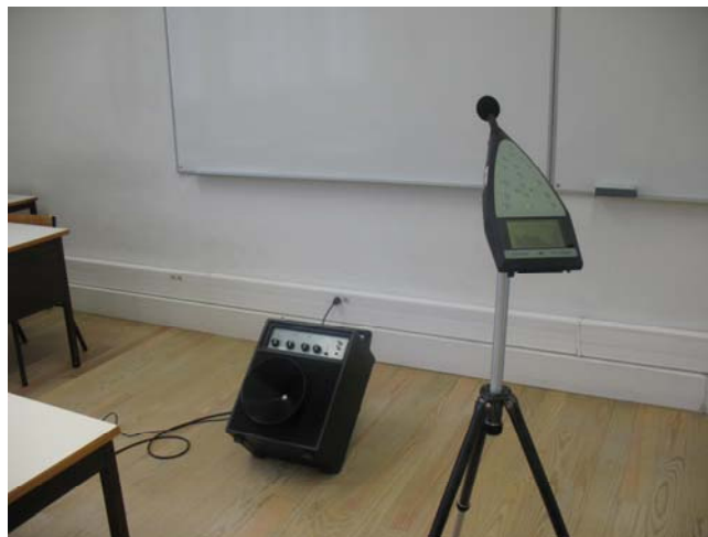
Figura 7.1 – Fonte sonora e sonómetro utilizados para os ensaios de isolamento sonoro a ruídos de condução aérea na Escola Secundária Rodrigues de Freitas [fotografia da autora]
