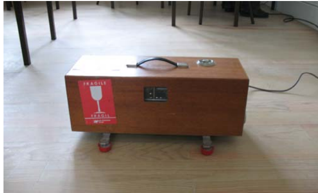
Figura 7.5 – Máquina de impactos normalizada [fotografia da autora]
