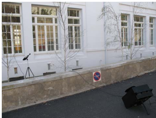
Figura 7.8 – Medição do isolamento sonoro a ruídos de condução aérea de fachadas na Escola Secundária Rodrigues de Freitas [fotografia da autora]
