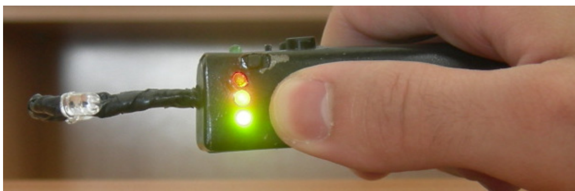
Figura 4.21: Verificação do estado das pilhas
