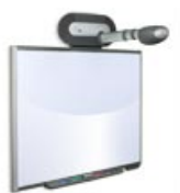
Figura 2.2: Quadro Interactivo de Projecção Frontal a curta distância
