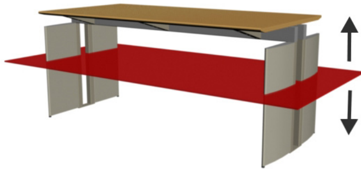
Fig. 17 - Representação de um plano de corte horizontal posicionado no centro geométrico da secretária Mater .
