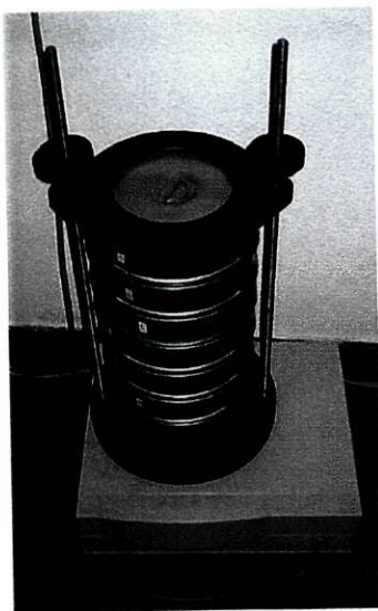
Figura 21 – Sistema de vibração de tamizes.
