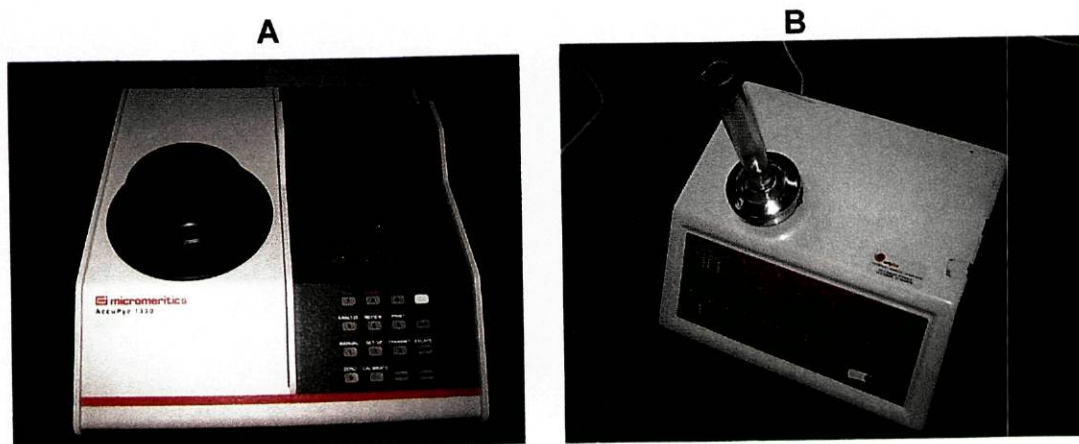
Figura 23 – (A) Picnómetro a hélio; (B) Aparelho de compactação.
