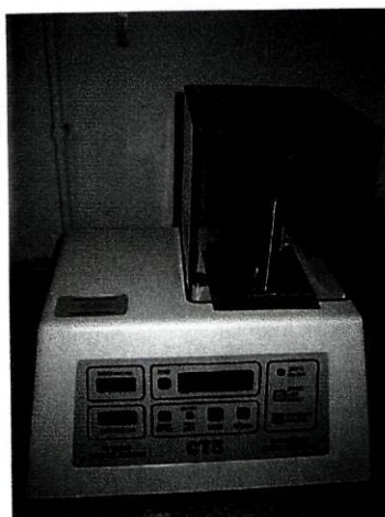
Figura 26 - Aparelho para determinação da resistência ao esmagamento dos comprimidos.
