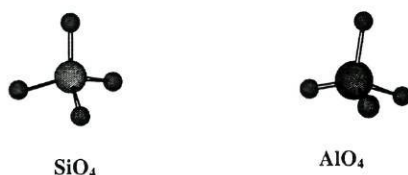
Figura 1.1 As unidades primárias dos zeólitos: tetraedros de \text{SiO}_4 e \text{AlO}_4 .
