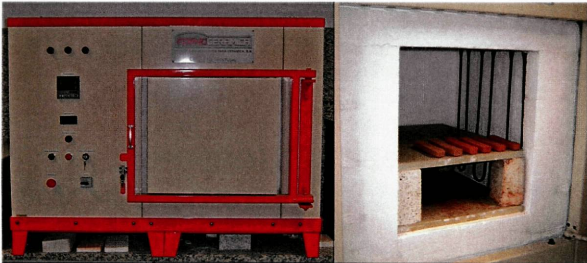
Figura 7.7 – Aspecto do forno cerâmico utilizado no laboratório do INETI, em São Mamede Infesta, para o processamento dos provetes a utilizar nos ensaios tecnológicos.
