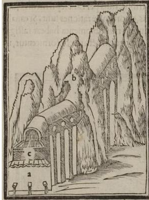
Fig. 4 - Três tanques emisários (a), aqueduto subterrâneo (b), e castelum (c) (VITRÚVIO - M. Vitruvius per locundum solito castigatior factus cum figuris et tabula ut iam legi et intellegi possit . Transcrição e gravuras de Fra Giocondo. Venesa: Giovanni da Tridentino, 1511. fl. 81v.).
