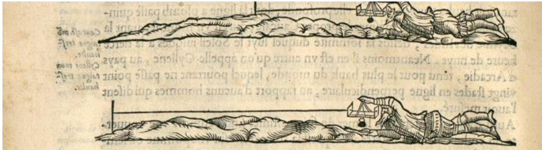
Fig. 18 - Métodos para medir as alturas e desníveis dos terrenos (ALBERTI, Leon Battista – L'architecture et art de bien bastir du seigneur Leon Baptiste Albert, diuisée en dix livres . Tradução de Jaques Kerver. Paris: Libraire luré, 1553. fl. 211v.).
