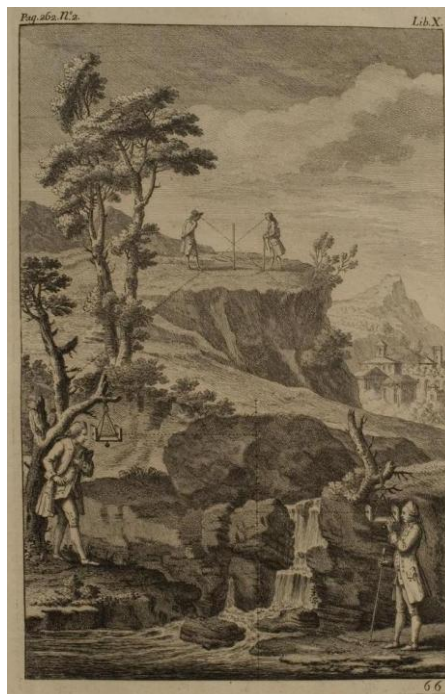
Fig. 24 - Métodos para medir as alturas e desníveis dos terrenos (ALBERTI, Leon Battista - Della architettura di Leon Batista Alberti, della pittura e della statua . Tradução de Cosimo Bartoli. Bolonha: Intituto delle Scienze, 1782. Gravura 66).
