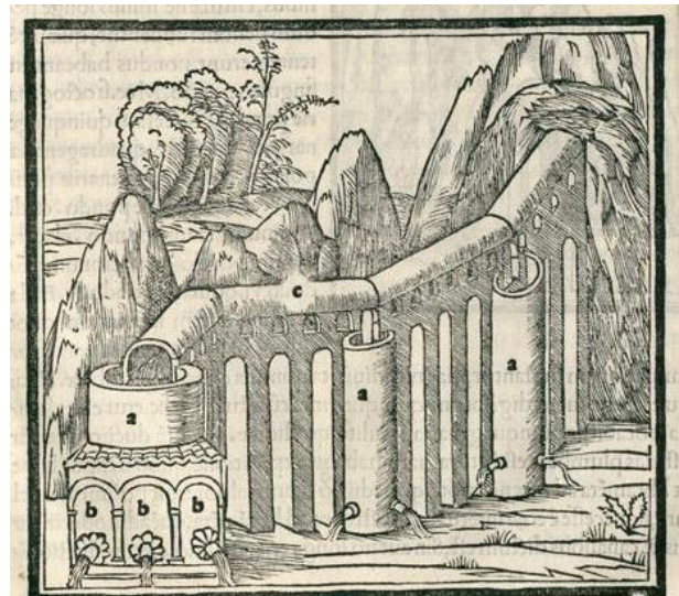
Fig. 3 - Castelum (a), três tanques emisários (b) e arcadas do aqueduto (c) (VITRÚVIO - M. Vitruvius per locundum solito castigatior factus cum figuris et tabula ut iam legi et intellegi possit . Transcrição e gravuras de Fra Giocondo. Venesa: Giovanni da Tridentino, 1511. fl. 80v.).
