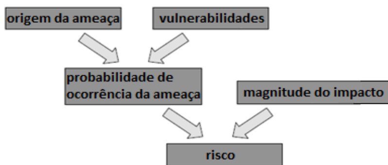
Figura 5 – Princípio para determinar o Risco
