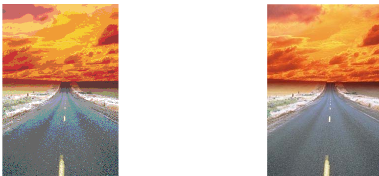
Figura 3-4 A mesma imagem, com ficheiros de tamanhos idênticos, mas em formatos diferentes GIF (à esquerda) e JPEG (à direita).
