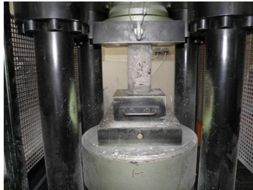
Fig. 3.19 – Prensa de ensaio de compressão simples
