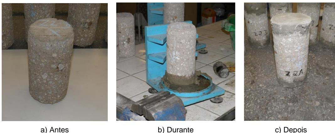
Fig. 3.18 – Rectificação dos provetes por capeamento
