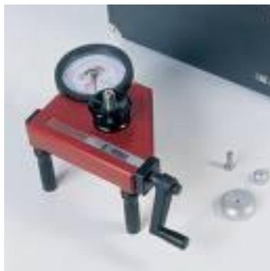
Fig. 3.21 – Equipamento de ensaio de Pull-Off
