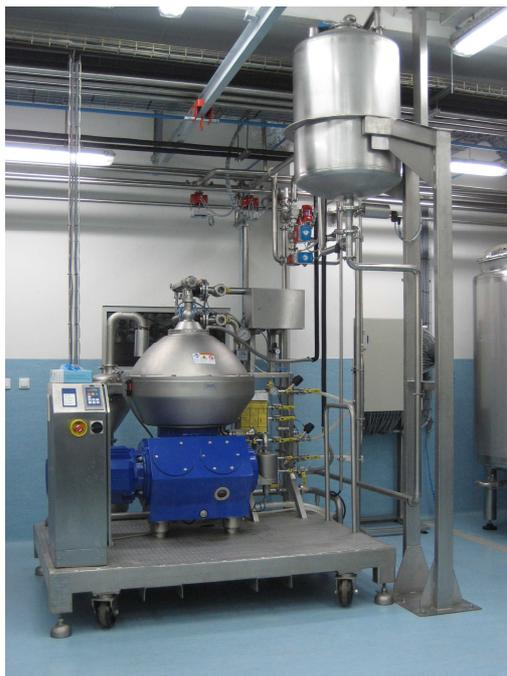
Figura 7 - Centrifugadora Clara 200, Alfa Laval
