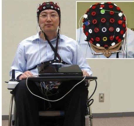
Figura 3.1.3.9b - Protótipo de cadeira de rodas inteligente conduzida por ondas cerebrais [40]
