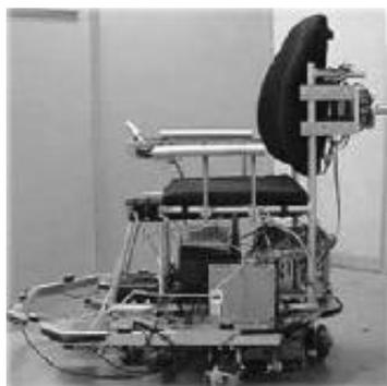
Figura 3.1.3.2 - Protótipo de cadeira de rodas inteligente omnidireccional
