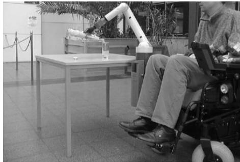
Figura 3.1.3.7 - Braço robótico MANUS aplicado a uma cadeira de rodas
