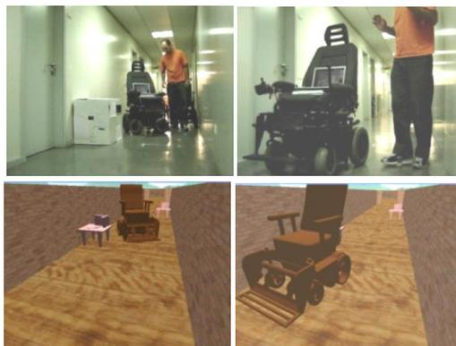
**Figura 2.1.4 - Representação real e virtual das posições inicial e final do movimento da cadeira de rodas inteligente**
