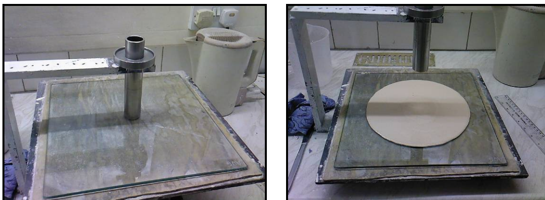
Figura 3.74 – Ensaio de fluidez de gesso.
