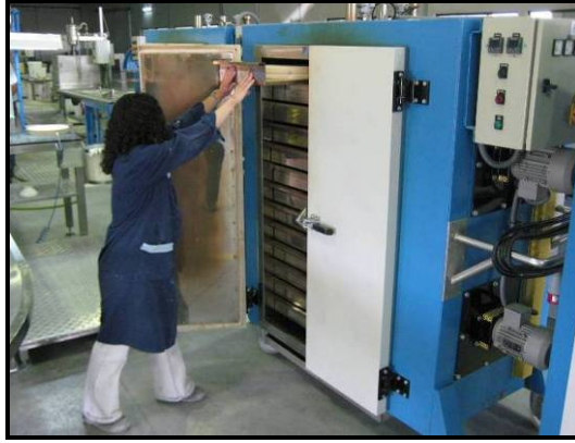
Figura 3.11 – Colocação da moldação no interior da mufla de secagem de moldações.
