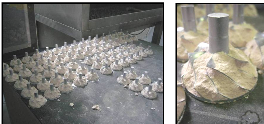
Figura 3.34 – Impulsores fundidos após a operação de abate de uma moldação.
