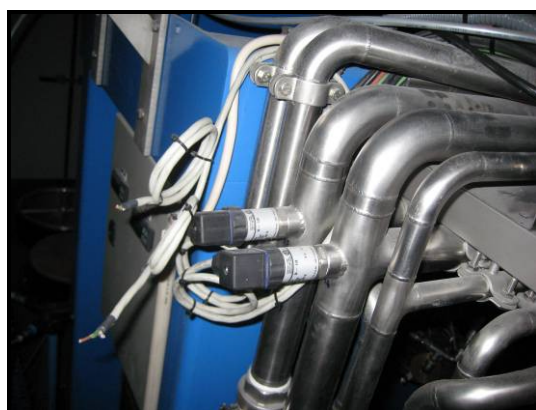
Figura 3.100 – Sensores de vácuo analógicos WIKA Transmitter S-10 fixos às tubagens de “Vácuo Total” e “VácuoParcial”.
