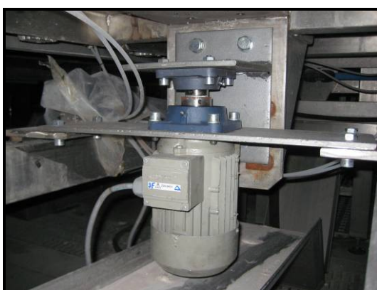
Figura 3.91 – Sistema de vibração do posto de vazamento de moldações com um excêntrico.
