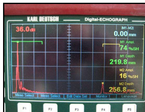
Figura 3.57 – Sinal recebido durante a inspecção de uma peça por ultra-sons.
