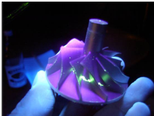
Figura 3.62 – Impulsor durante a inspeção com iluminação ultravioleta.
