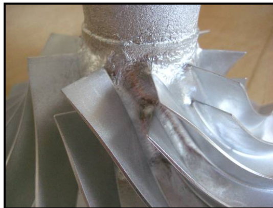
Figura 3.65 – Impulsor com vestígios de reacção metal-gesso.
