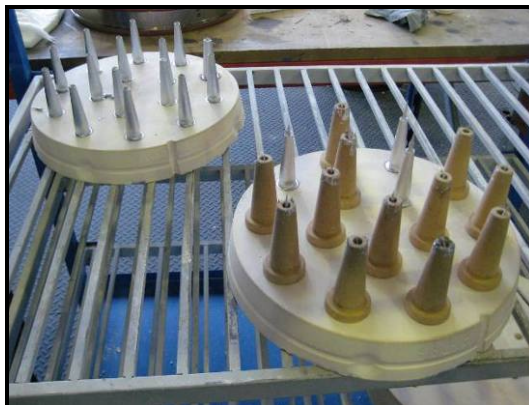
Figura 3.30 – Moldação vazada colocada num trolley de transporte para arrefecimento.
