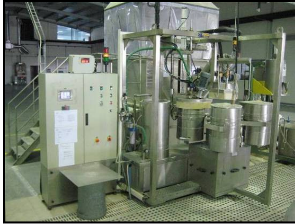
Figura 3.3 – Máquina de mistura automática de gesso com água em vácuo.
