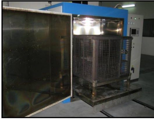
Figura 3.53 – Movimentação do cesto para o interior da câmara do forno de envelhecimento.
