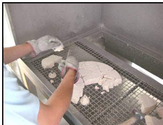
Figura 3.33 – Abate de uma moldação vazada.
