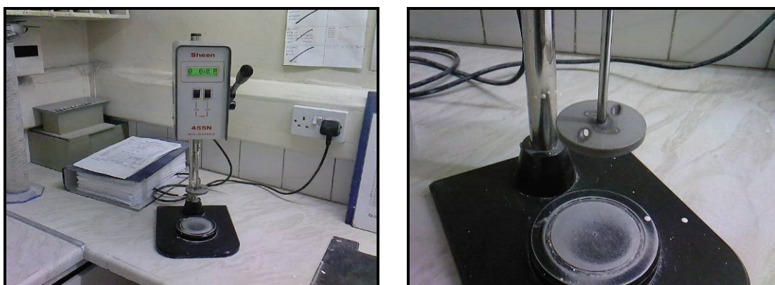
Figura 3.75 – Máquina de ensaio de viscosidade Sheen Digital Rotoviscometer 455N/15 , e respectivo disco perfurado.
