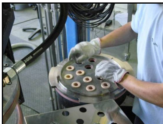
Figura 3.24 – Colocação dos tubos de aspiração na placa porta-tubos.
