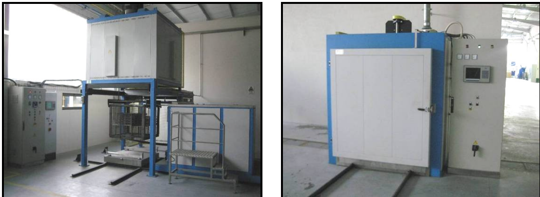
Figura 3.45 – Fornos de homogenização e de envelhecimento, respectivamente.
