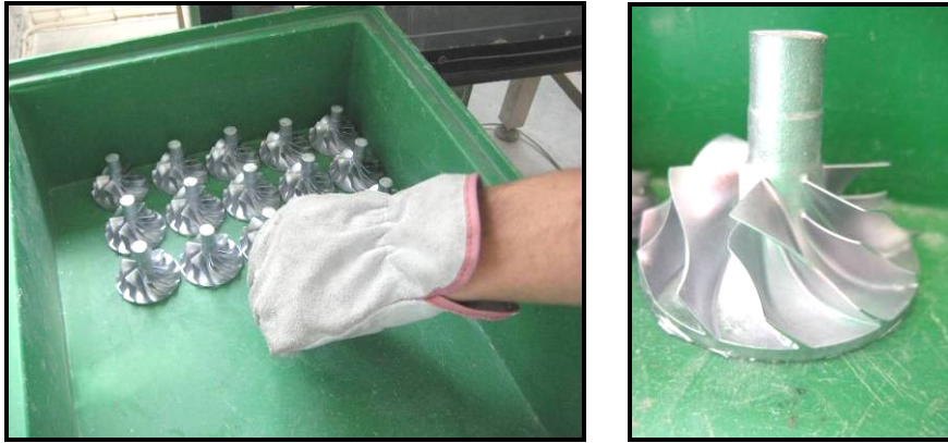
Figura 3.36 – Colocação de impulsores num dos tabuleiros de transporte, e impulsor após a operação de vibração pneumática.
