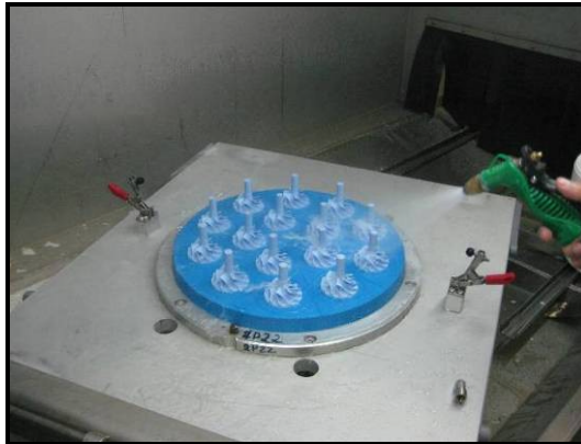
Figura 3.12 – Lavagem de uma placa-molde.
