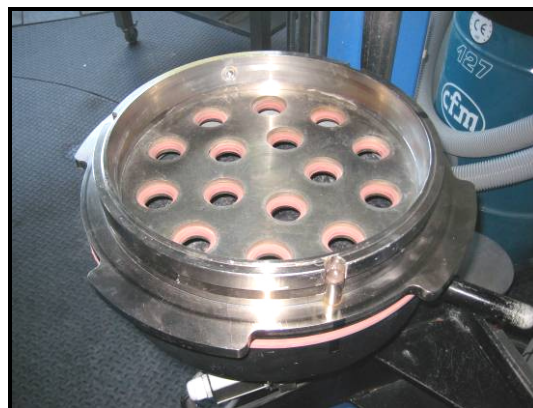
Figura 3.19 – Anel de compressão radial da moldação sobre a placa porta-tubos.
