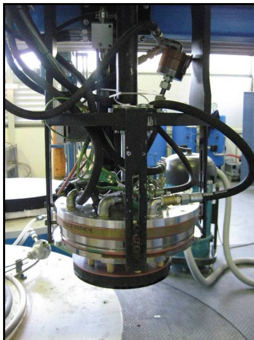
Figura 3.27 – Câmara de vazamento no “Posto de Purga”, pronta para efectuar a purga e a injeção de argon.
