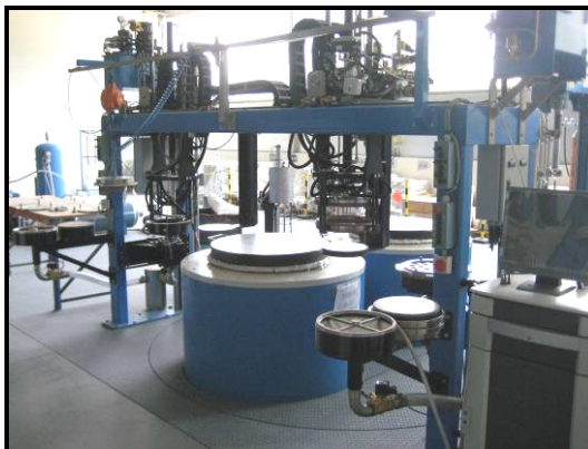
Figura 3.16 – Forno duplo de fusão/manutenção de alumínio e respectivo pórtico com duplo posto de vazamento.
