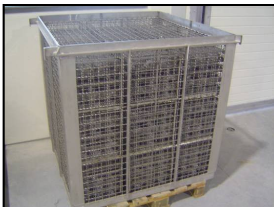
Figura 3.43 – Cesto de tratamentos térmicos carregado com impulsores prontos a tratar termicamente.
