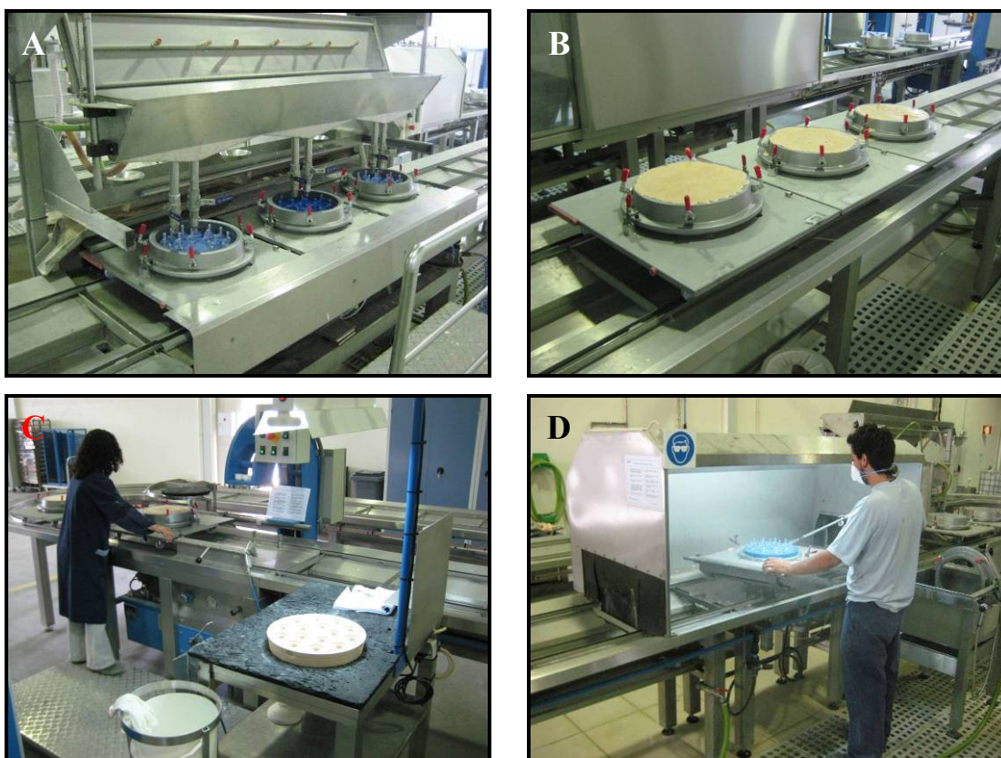
Figura 3.5 – Postos de trabalho na linha de produção de moldações em gesso (A → Posto de vazamento; B → Posto de nivelamento; C → Posto de desmoldação; D → Posto de lavagem de placas-molde).
