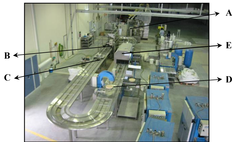
Figura 3.4 – Linha de produção de moldações (A → Máquina de mistura; B → Posto de vazamento; C → Posto de nivelamento; D → Posto de desmoldação; E → Posto de lavagem de placas-molde).
