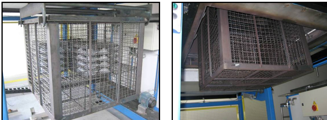
Figura 3.51 – Sequência de subida do cesto para o interior da câmara do forno de homogenização.
