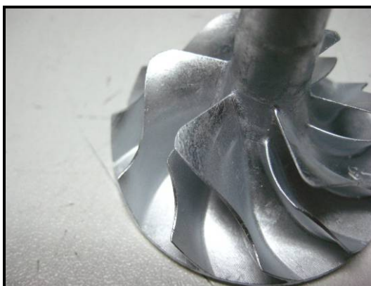
Figura 3.95 – Impulsor com alhetas mal-cheias.
