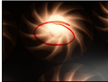
Figura 3.96 – Chapa de inspeção de um impulsor com um poro interno em Raio X.
