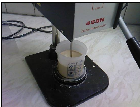
Figura 3.76 – Ensaio de viscosidade de gesso.
