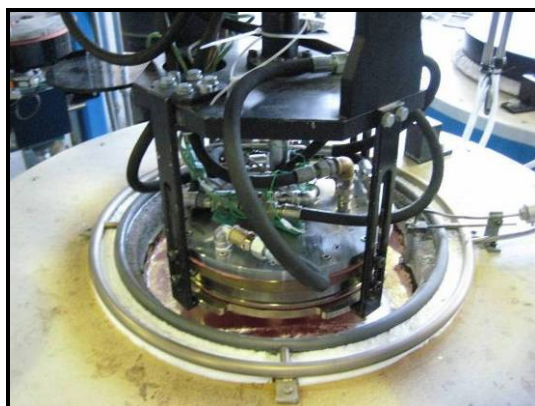
Figura 3.28 – Câmara de vazamento no “Posto de Vazamento”, durante o vazamento de alumínio na moldação.
