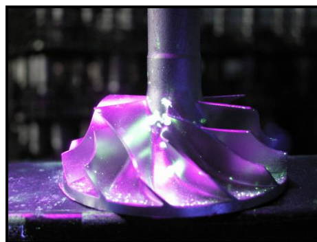
Figura 3.97 – Impulsor com óxidos superficiais, detectados por líquidos penetrantes.
