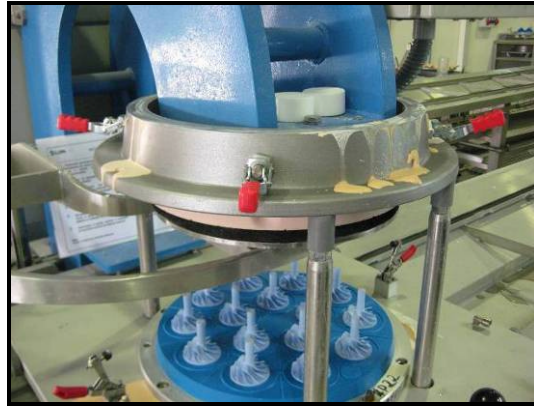
Figura 3.8 – Extracção da moldação de gesso da placa-molde (desmoldação).
