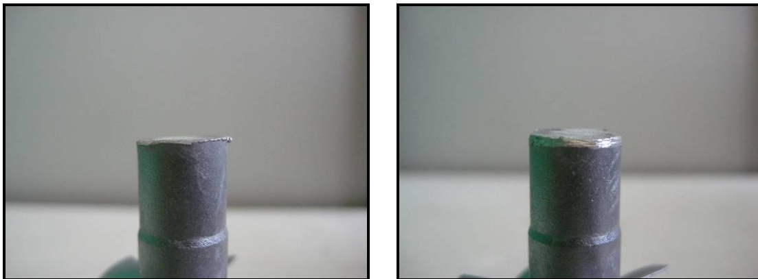
Figura 3.37 – Aspecto do topo do tarugo de uma peça antes e depois da rebarbagem.
