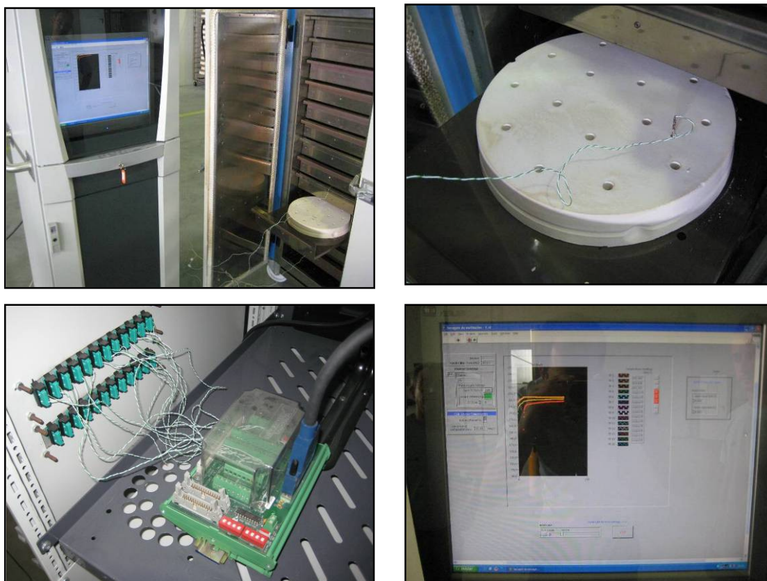
Figura 3.77 – Sistema informático de aquisição de dados, respectiva placa de aquisição analógica-digital National Instruments TBX-68T , e interface de comunicação com o operador.
