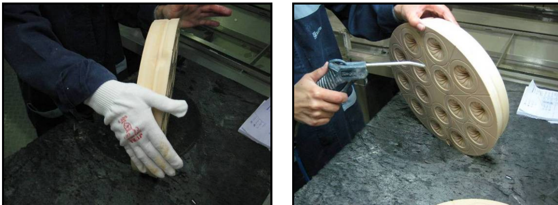
Figura 3.10 – Eliminação de rebarbas e de arestas vivas, e limpeza da moldação com ar comprimido.
