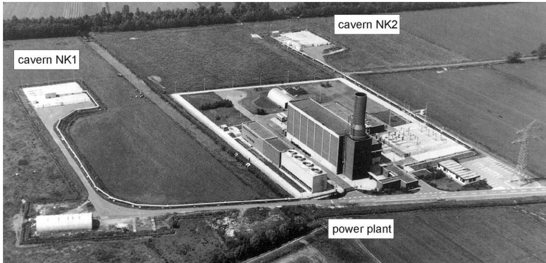
Figura 2.5 - Vista aérea da central com sistema de armazenamento a ar comprimido em Huntorf [20].
