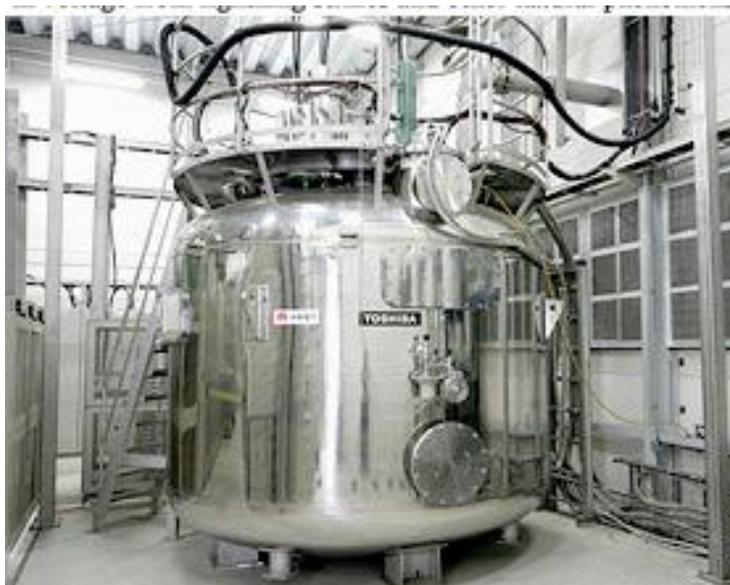
**Figura 2.23** - Dispositivo de armazenamento de energia em supercondutores magnéticos [48].
