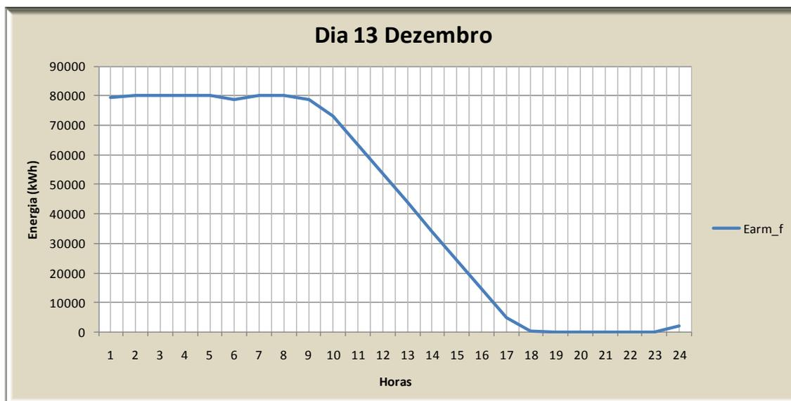
Figura 4.19 - Energia armazenada pelo sistema de armazenamento.
