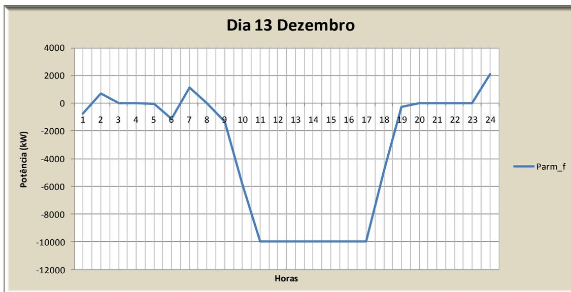
Figura 4.18 - Potência do sistema de armazenamento ao longo do dia em questão.
