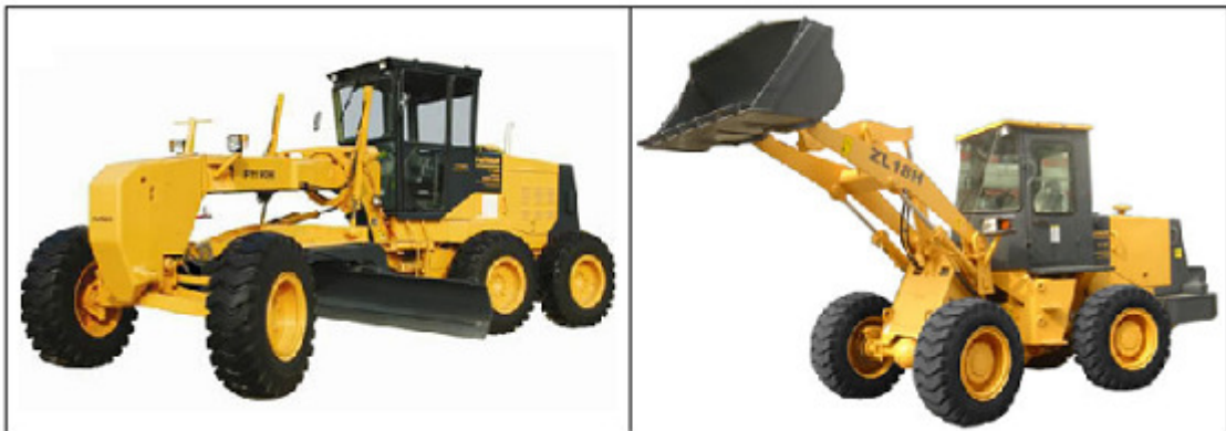
Fig.2.26 – Esquerda: Motoniveladora; Direita: Pá carregadora ( www.changlin.com.pt ).
