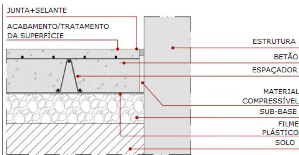
Fig.2.22 – Corte: Junta de dessolidarização (Cristelli, 2010).
