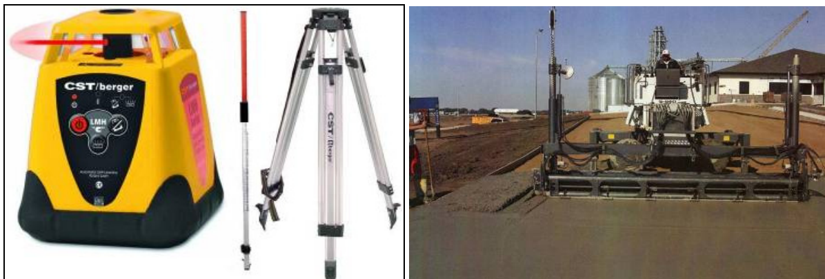
Fig.2.33 – Esquerda: Laser, régua graduada e tripé ( www.kuantokusta.pt ); Direita: Laser screed ( www.screedtech.net ).
