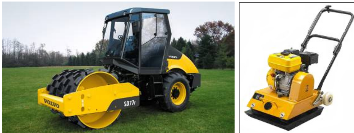
Fig.2.27 – Esquerda: Cilindro pés de carneiro ( http://www.volvo.com.ai/constructionequipment/europe/ptpt/products/compactors/Largesoil/SD77F/introduction.htm?TAB=1 ); Direita: Placa vibratória ( http://por.chuangmei.com/ ).
