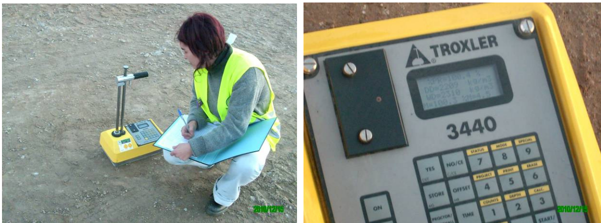
Fig.5.15 – Equipamento radioactivo para controlo da compactação - Troxler 3440.
