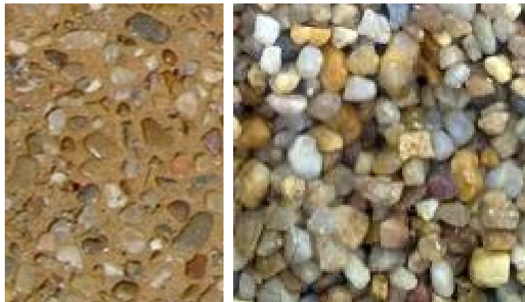
Fig.3.7 – Esquerda: Betão lavado; Direita: Betão poroso ( www.pavieste.pt ).
