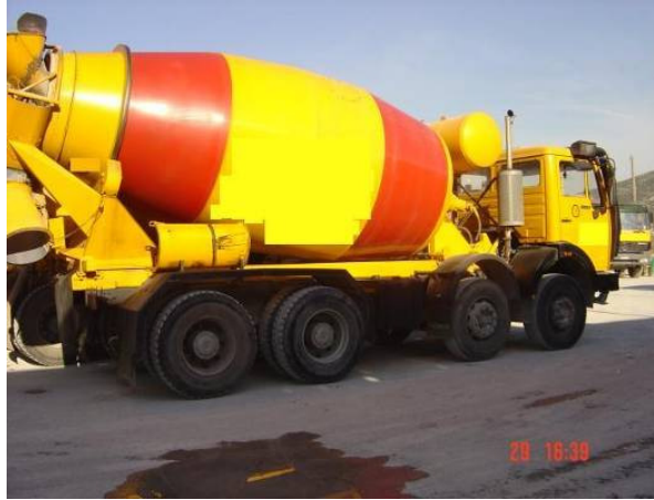
Fig.2.31 – Camião auto-betoneira ( www.braskraft.com.br ).
