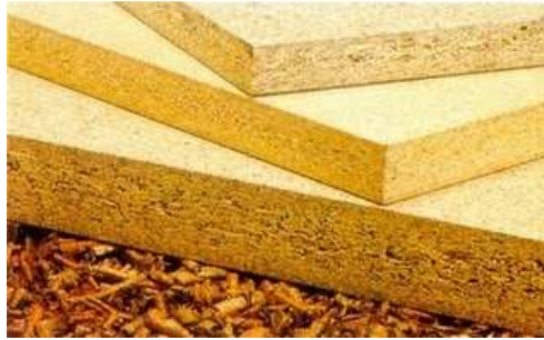
Fig.3.4 – Aglomerado de partículas de madeira [http://portaldamadeira.blogspot.com, 2010]
