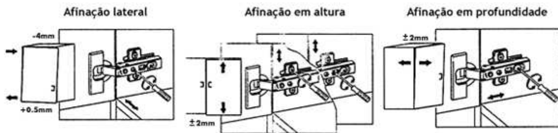
Figura 6: Como executar as afinações nas dobradiças ocultas
