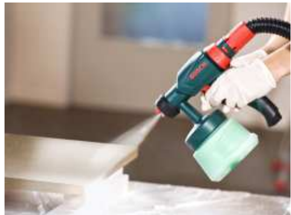
Figura 2: Aplicação de verniz com pistola de pulverização
