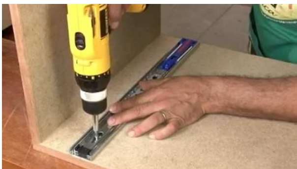
Figura 3: instalação da corrediça na lateral do corpo do móvel
