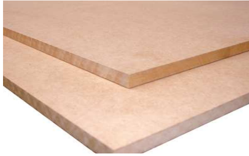
Fig.3.5 – Aglomerado de fibras (MDF) [www.banema.pt, 2010]
