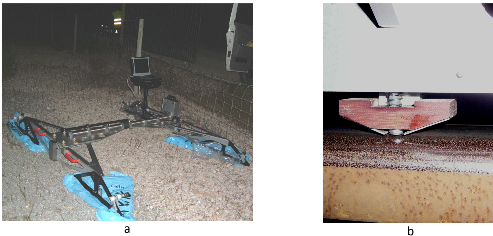
Figura 8.19 – Equipamento de medição de corrugação: a) vista geral; b) pormenor do sensor.
