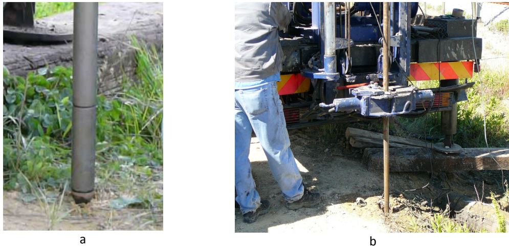
Figura 8.5 – Ensaio CPTU: a) Pormenor da ponteira; b) Sistema de reacção.
