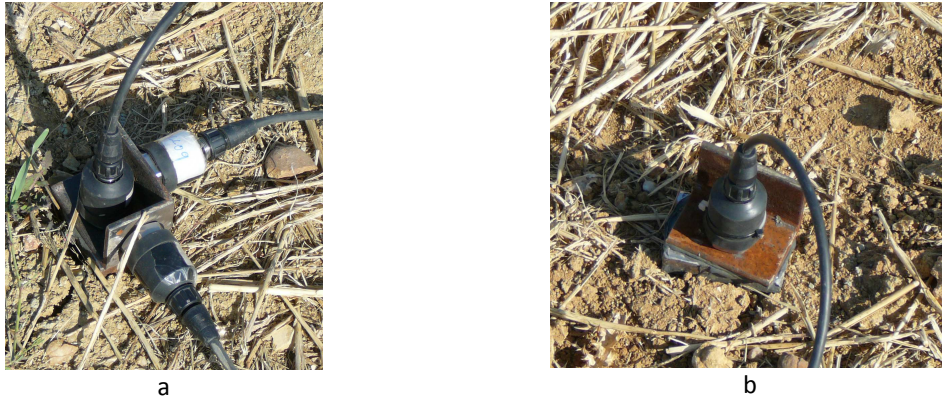
Figura 8.34 – Medição de acelerações na superfície do terreno adjacente à via: a) medição em três direcções ortogonais; b) medição na direcção vertical.
