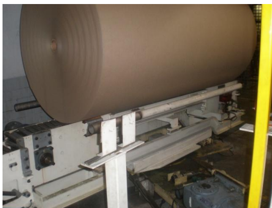
Figura 70 – Conveyor rotativo de bobines ( cortesia da Europac Kraft Viana )
