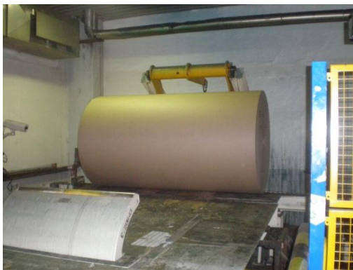
Figura 73 – Conveyor linear de bobines ( cortesia da Europac Kraft Viana )
