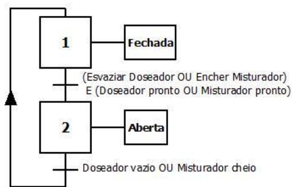
Figura 100 – GRAFCET base de um possível bloco partilhado que encapsula uma válvula
