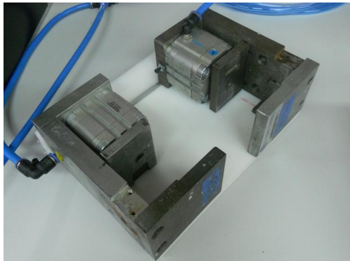
Figura 23 – Sistema de ar comprimido destinado ao fecho do disjuntor.
