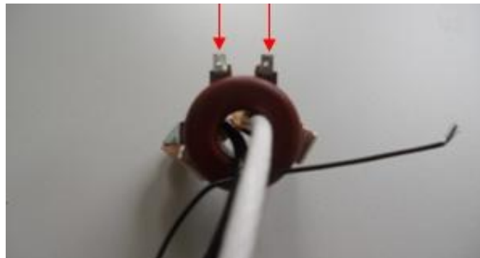
Figura 30 – Pontos de furação das patilhas do núcleo do conjunto diferencial.
