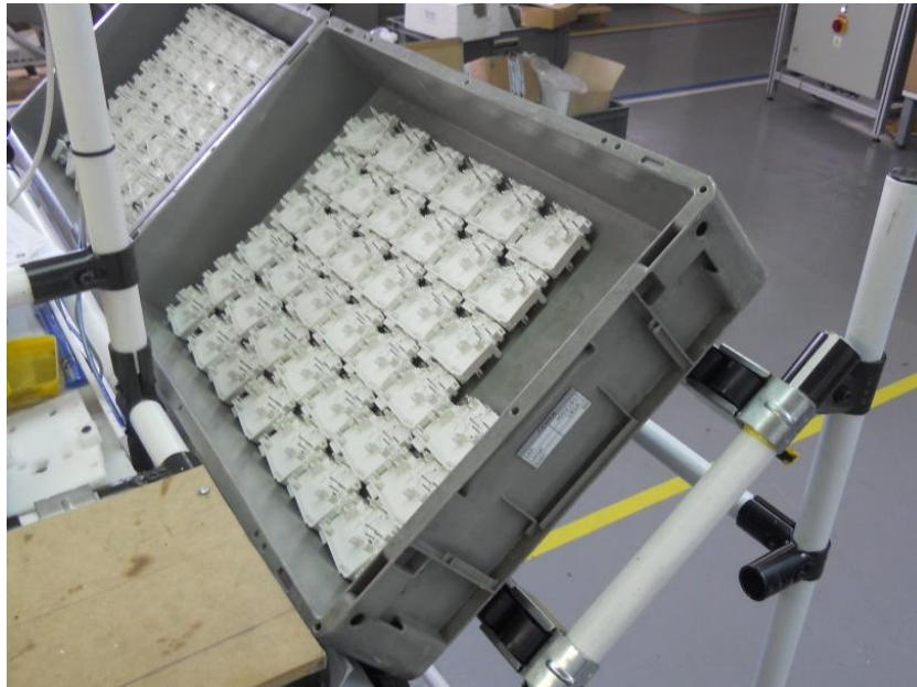
Figura 37 – Sistema lateral e deslizante de abastecimento de módulos plásticos.
