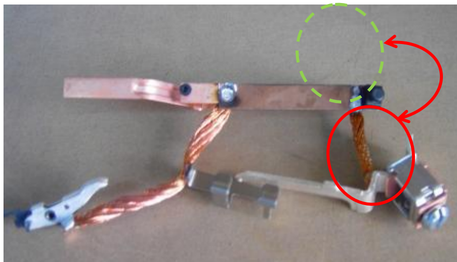
Figura 31 – Alteração em 180° da posição de soldadura da trança do borne longo no térmico de fase.
