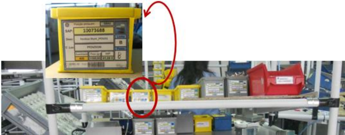
Figura 35 – Imagem do bordo de linha e das identificações nos contentores de abastecimento.
