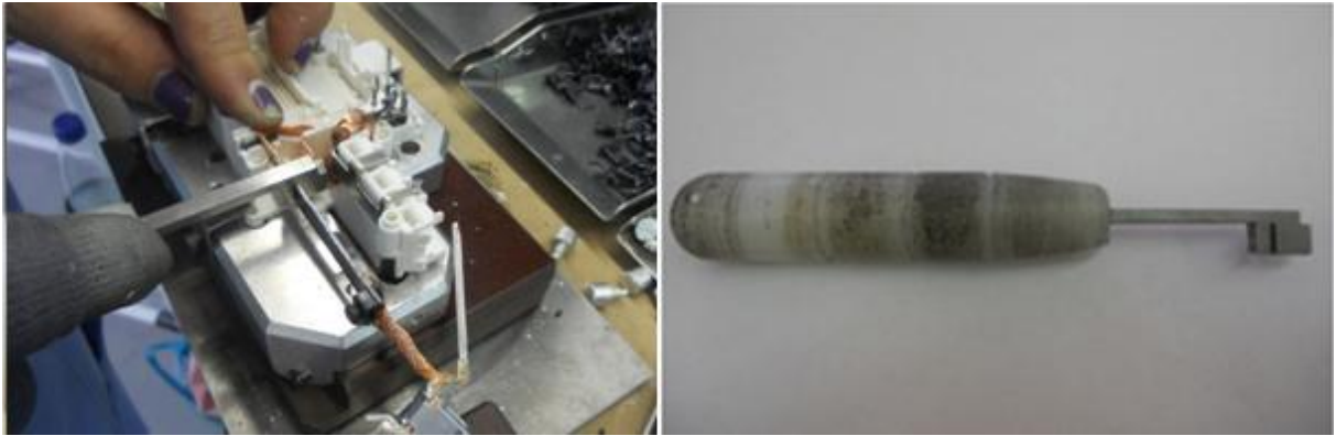
Figura 22 – Ferramenta de calibração bimetal no controlo de qualidade do produto 2P1545S.
