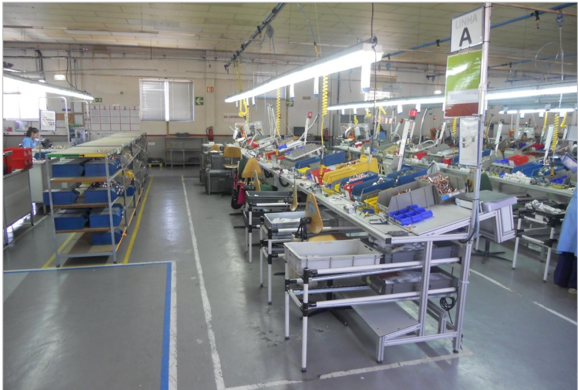
Figura 12 – Linha de montagem do ELCB, do produto 2P1545S.
