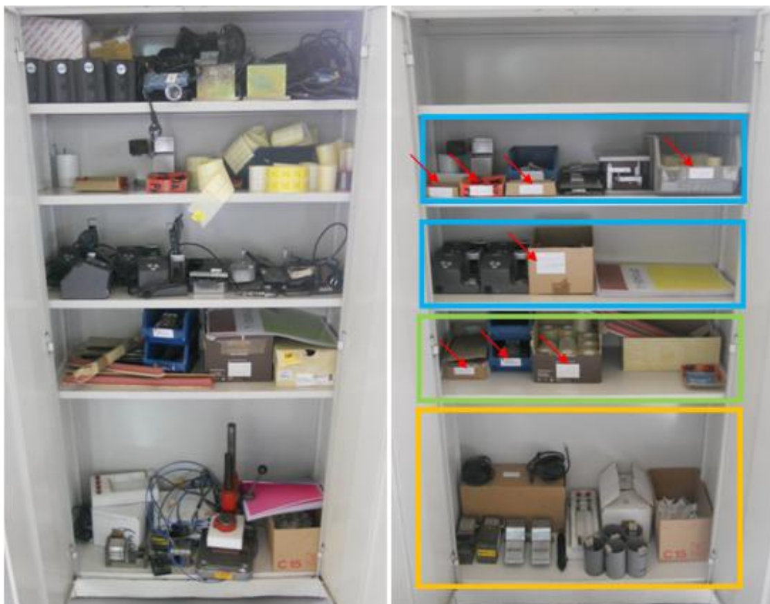
Figura 36 – Aplicação 5S no armário de ferramentas do ELCB. À esquerda antes da aplicação 5S e à direita depois da metodologia 5S.
