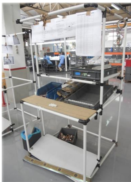
Figura 19 – Protótipo da estação de trabalho modular modelo para a célula de montagem.
