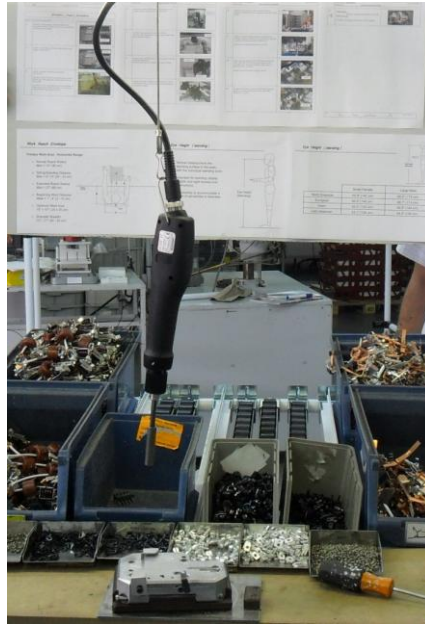
Figura 39 – Gestão visual aplicada à estação montagem do módulo térmico (estação 1).
