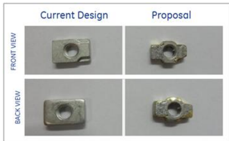
Figura 32 – Alterações propostas de uniformização na porca do shunt.
