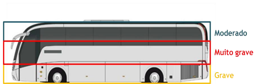
Figura 14 - Criticidade dos defeitos segundo a sua localização.
