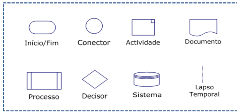
Figura 1 - Simbologia básica de fluxogramas (usada na CaetanoBus).
