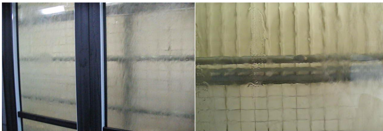
Figura 36 - Porta lado esquerdo: projecção de água com bicos actuais; Porta lado direito: projecção de água bicos K. Figura 37 - Projecção de água com bicos K com casquilhos de 45°.
