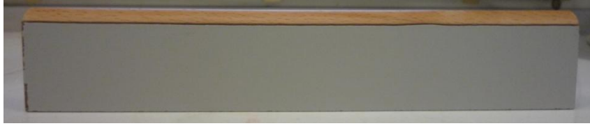
Figura 3.12 - Amostra de tampo com orla acabada com verniz de cura UV
