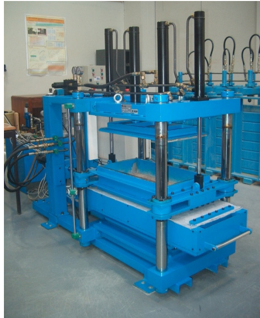
Figura 2.11 – Vista geral do equipamento de ensaio de corte directo do LGS-FEUP.
