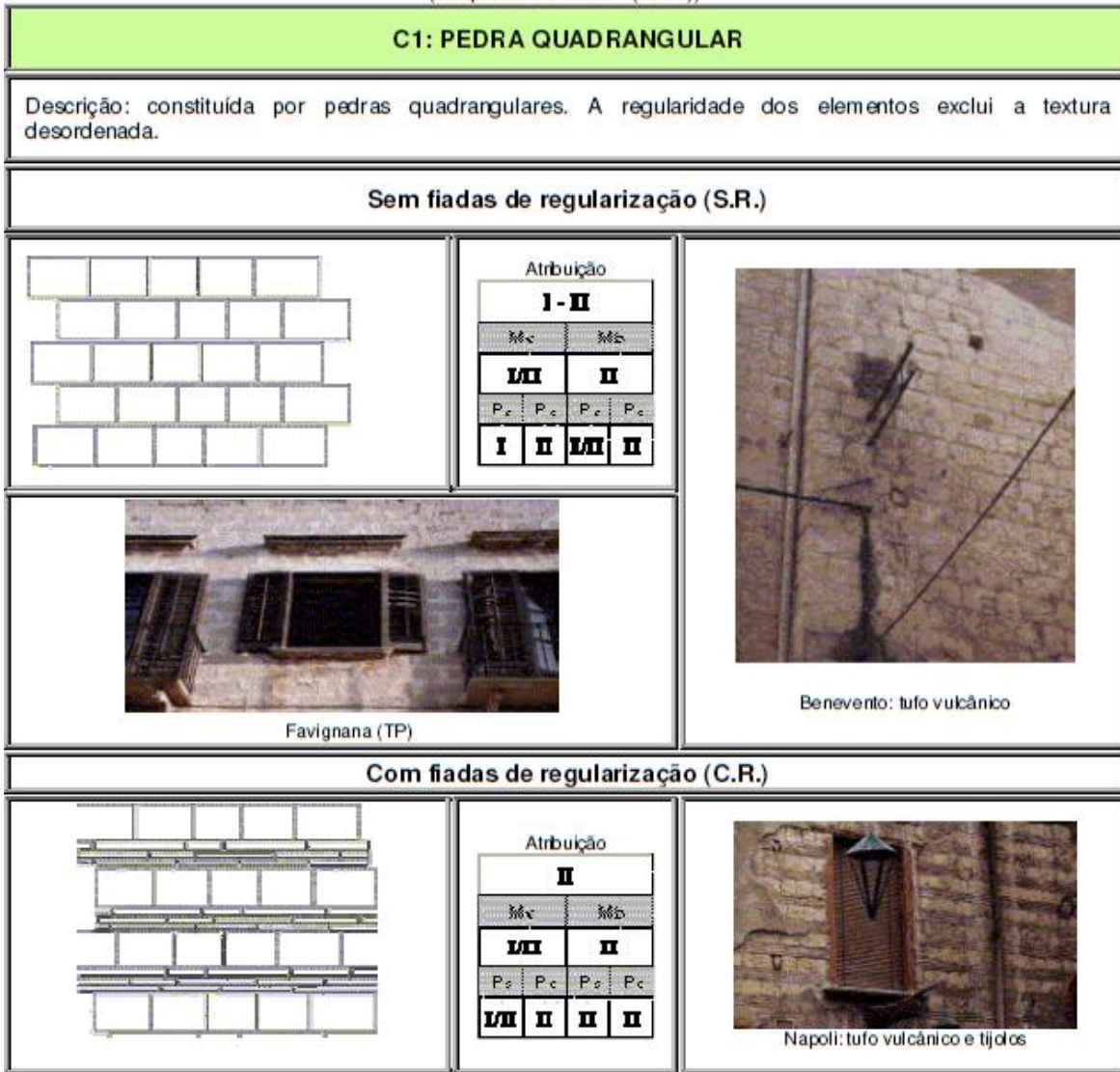
Fig. 2.21 – Alvenaria C1, ábaco do 2º e 3º níveis de conhecimento ((GNDT, 2000) adaptado por Liliana Sousa, 2010)
