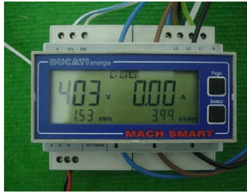
Figura 4.8.1 Analisador de energia Mach Smart da Ducati
