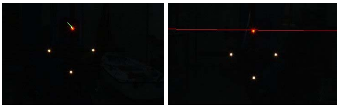
Figura 5.2.1 Linha epipolar calculada através do ponto seleccionado na imagem 1
