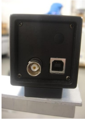
Figura 4.1.2 Entradas USB e Trigger das câmaras usadas
