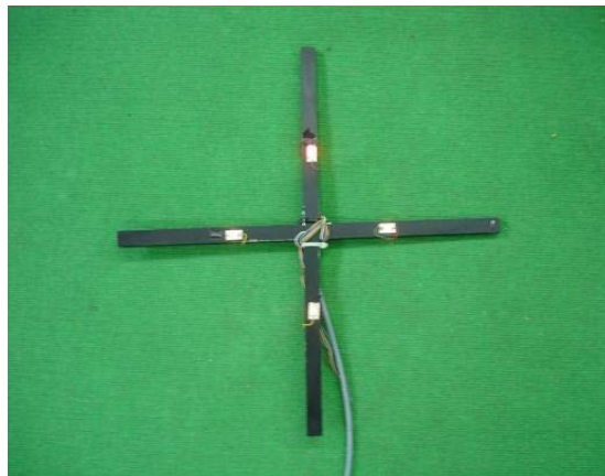
Figura 4.2.1 Suporte construído para colocar os marcadores
