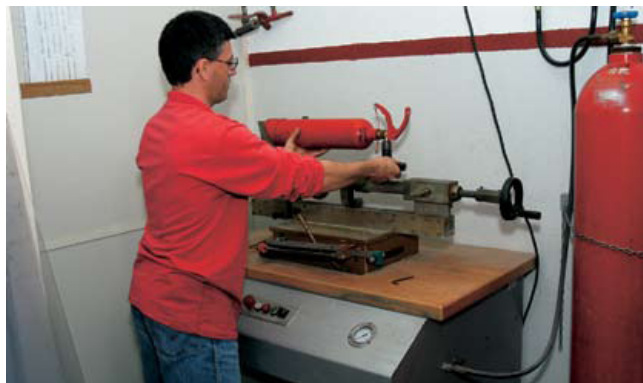
Fig. 8.3 – Recarga de extintores de CO 2 .
