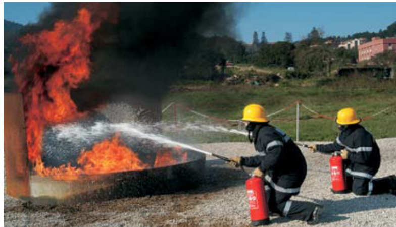
Fig. 9.14 - Espuma projectada para a parede do recipiente.
