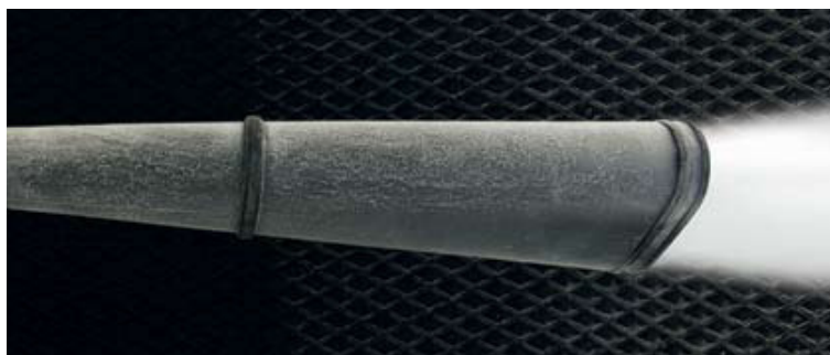
Fig. 5.4 – Formação de «camada de gelo» no difusor do extintor de CO 2 .
