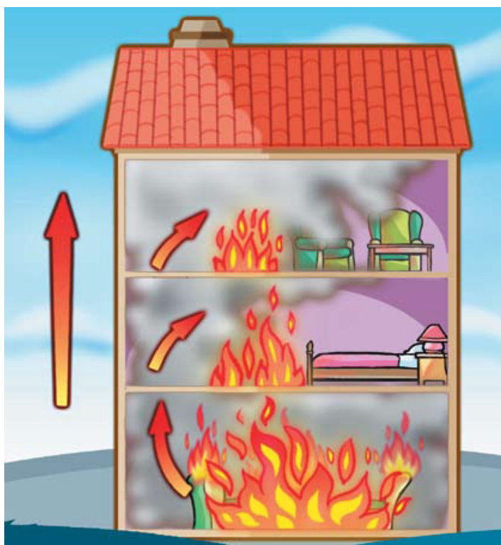
Fig. 3.5 – Transmissão de calor por convecção.
