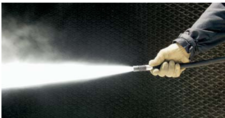
Fig. 5.5 – Projecção de pó químico seco.
