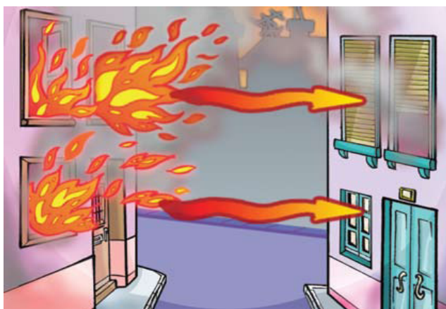
Fig.3.3 – Transmissão de calor por radiação.
