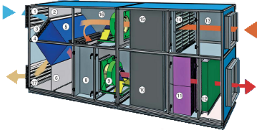
Fig. 16 – Identificação dos componentes típicos existentes em UTA's [36]
