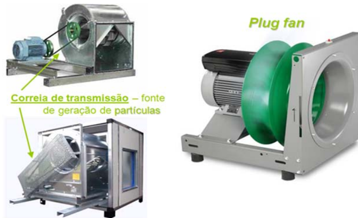
Fig. 18 – Ventiladores de acoplamento por correia (figura da esquerda); e ventiladores Plug-fan (figura da direita) – maior economia menor geração de partículas [36]
