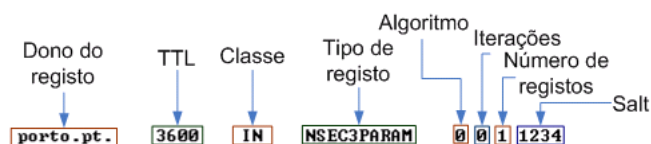
Figura 3.28: Esquematização dos elementos do NSEC3PARAM
